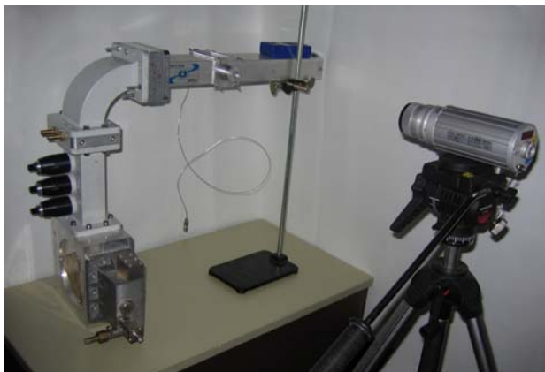
Versuchsstand zur Mikrowellensinterung von BeTi Kugeln.
