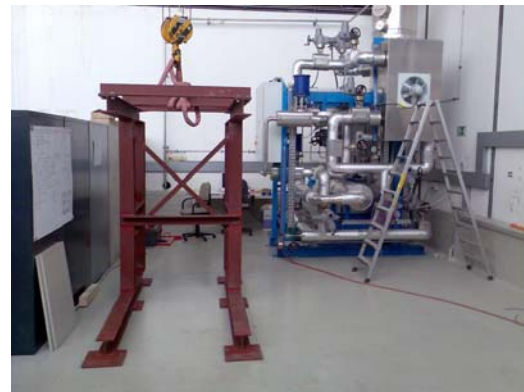
Schematischer Überblick über die Hauptbestandteile der Launcher Handling Test facility (oben) und Photographie der ersten Stufe des Prototypen-Aufbaus (Positionierung des Halterrahmens vor dem Kühlkreislauf).
