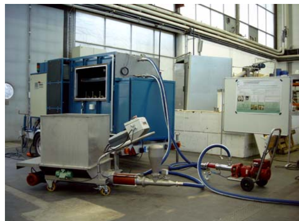
Maischeelektroporationsanlage KEA-WEIN mit angeschlossenen Maischepumpen nach dem Umbau.
