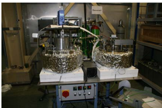
Aufgebauter und in Betrieb genommener Erosionsteststand.
