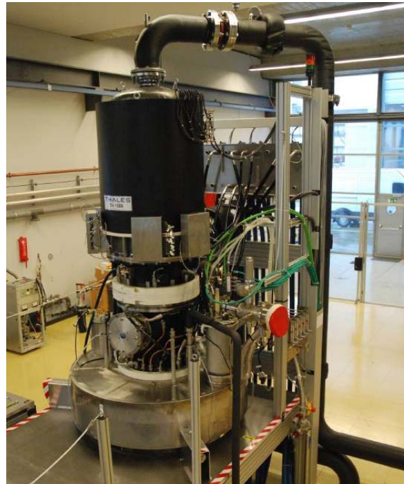
Prototyp des koaxialen 2 MW, 170 GHz Gyrotrons installiert im SL-Magneten mit allen notwendigen Anschlüssen
