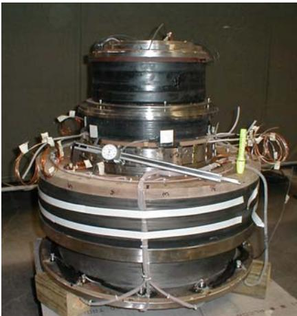
Montiertes Spulensystem des schnell durchstimmbaren Magneten (Fa. Cryomagnetics).
