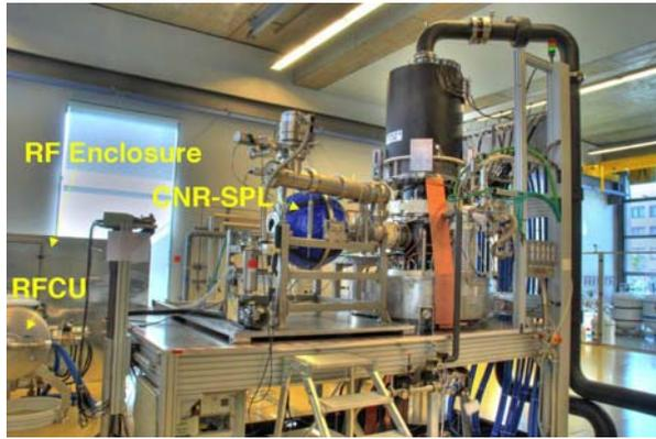
Fotographie der ersten industriellen Prototypröhre des 2 MW, CW, 170 GHz Gyrotrons mit koaxialem Resonator (hergestellt von TED), montiert im SL Magneten am CRPP Lausanne. Die blaue Kugel ist die angeschlossene Kurzpulslast des CNR.
