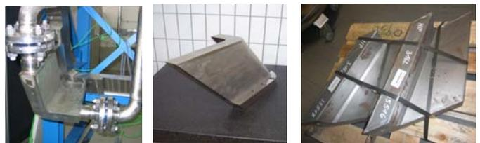
Mittels pulvermetallurgischer Fertigung (HIP, hot isostatic pressing) wurde ein Prototyp gefertigt und am Teststand eingesetzt (siehe Abbildung). Für einen weiteren Prototypen mit Hilfe von Lötung einzelner Wandkomponenten ergab sich eine Undichtigkeit durch Verzug während des Abkühlens.
