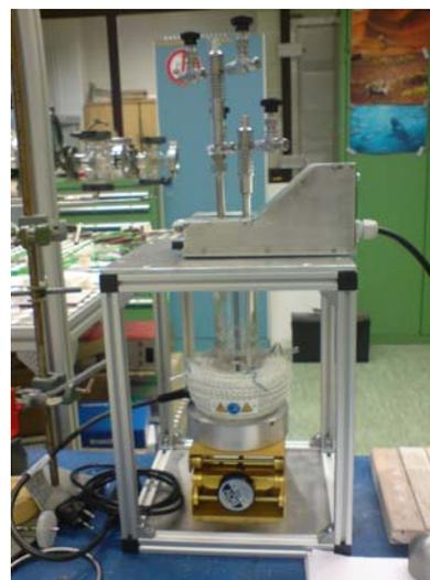
Photographie der Versuchskammer zur Bestimmung der Austauschrate von Sauerstoff zwischen Flüssigmetall und Gasphase.
