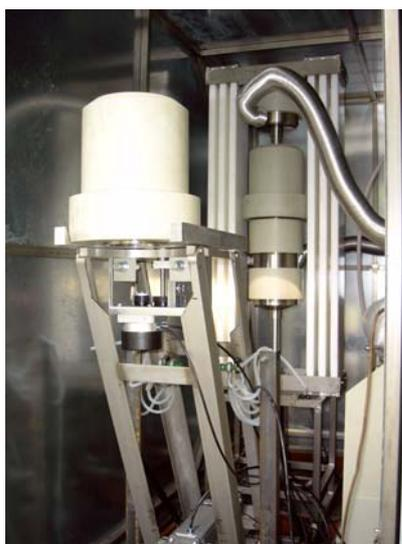
KEA-MOBIL: Wechselvorrichtung und Presse mit Versuchsgefäßen.
