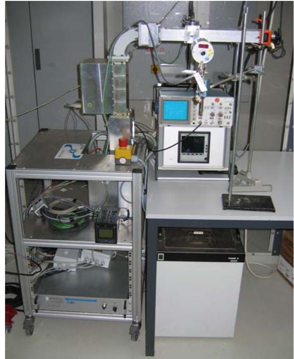
Versuchstand zur Mikrowellensinterung von BeTi Kugeln.
