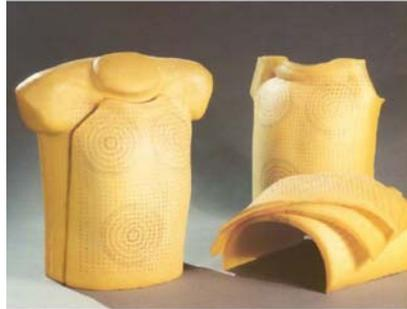
Abb. 6-45: Physikalisches Torso-Phantom zur Kalibrierung der Teilkörperzähler von HS (Nachbau des Lawrence Livermore National Laboratory (LLNL) Phantom [Gri78, Gri86])
