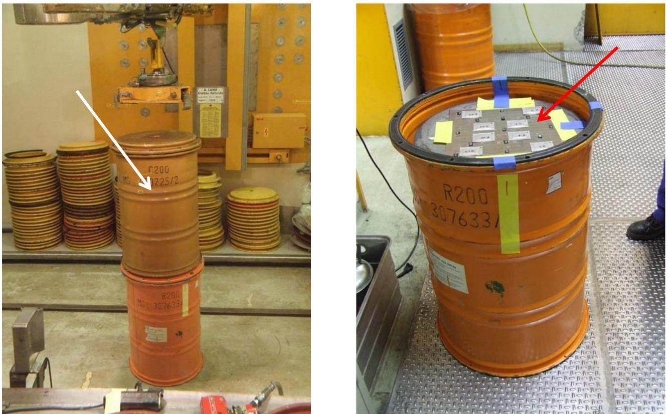
Abb. 6-21: Bestrahlungsaufbau mit Fässern. Links: Fass mit radioaktiven Inhalt (weißer Pfeil) auf dem Bestrahlungsfass; rechts: Bestrahlungsplatte mit Detektoren (roter Pfeil) auf der Presstrommel im Bestrahlungsfass
