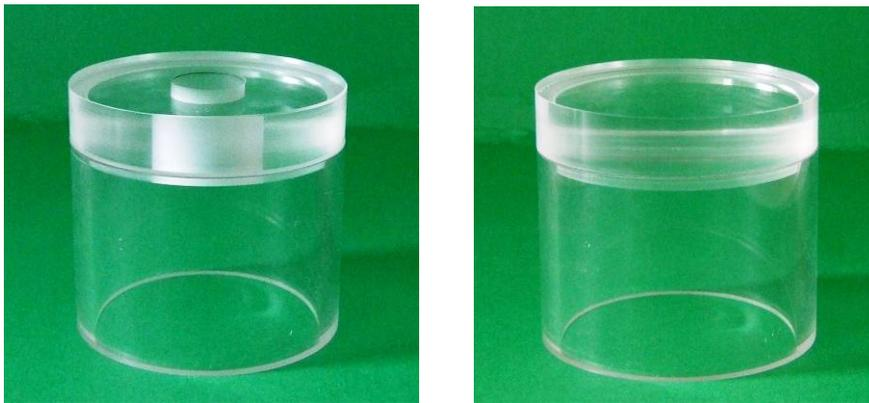
Abb. 6-4: Abschirmung mit Aussparung (links) und komplette Abschirmung (rechts) aus 2 cm Plexiglas, von HS-KES konstruiert und gefertigt
