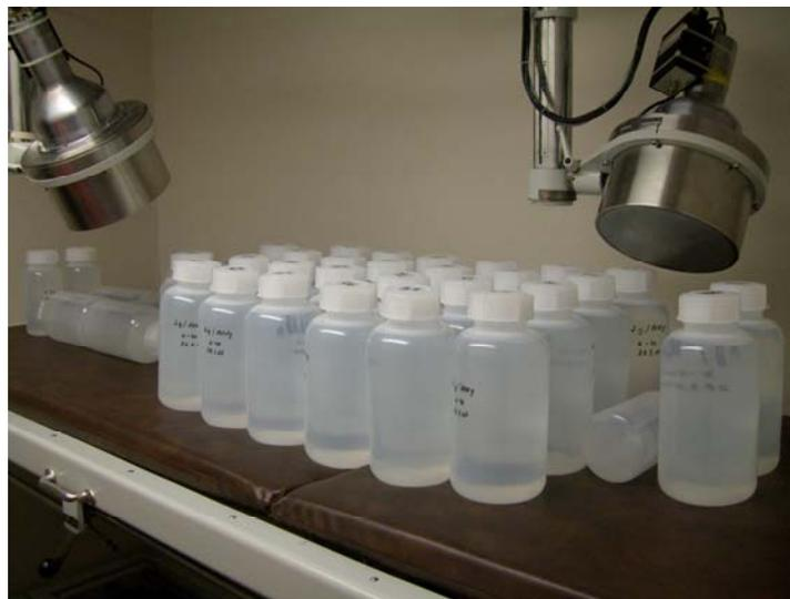
Abb. 5-10: Flaschenphantom K-40 in Standardmessposition im Ganzkörperzähler
