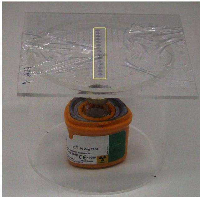
Abb. 6-3: Versuchsaufbau zur Messung der Ortsdosis: TLDs (gelbe Markierung) befanden sich 4 cm über dem geöffnetem Bleicontainer mit dem Transportvial, in dem sich das Y-90 befindet.
