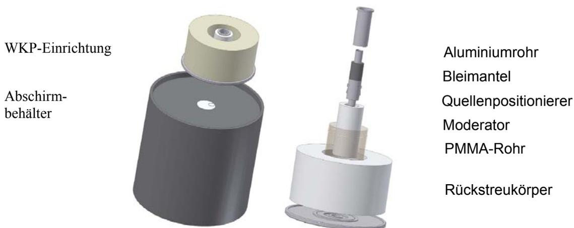
Abb. 6-36: links: CAD-Modell der Neutronen-WKP-Einrichtung mit Abschirmbehälter, rechts: Explosionszeichnung der WKP-Einrichtung [LIE08]
