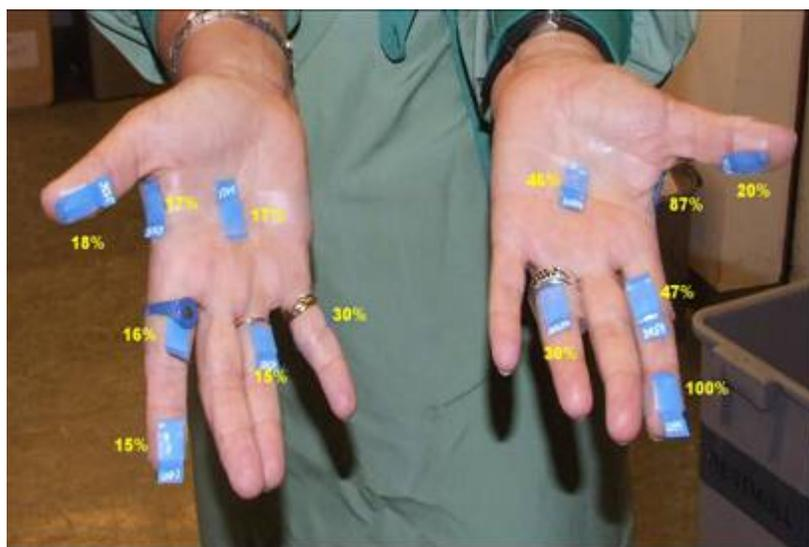
Abb. 6-6: Verteilung von  $H_p(0,07)$  an den Händen bei einer Vorbereitung zur SIRT; Maximalwert: 0,8 mSv (100 %)
