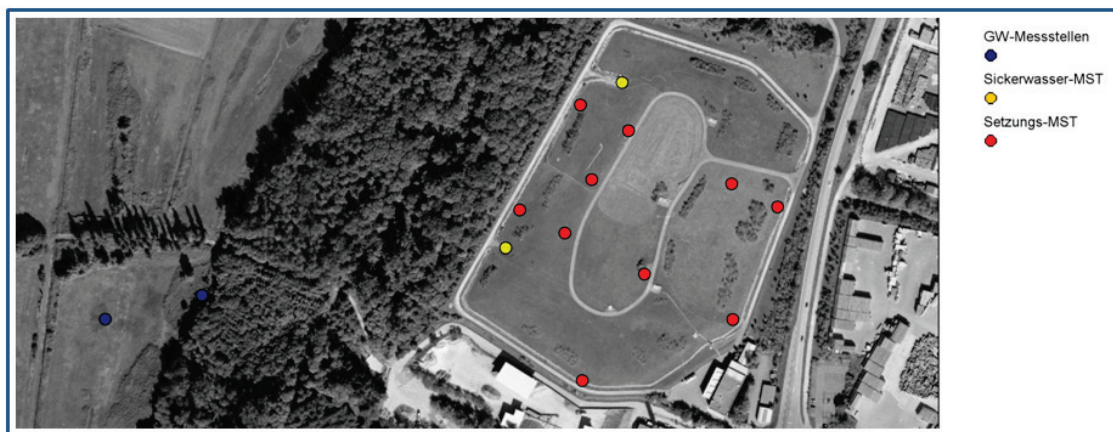
Abbildung 4: Visualisierung von Deponiemessstellen in GIS
