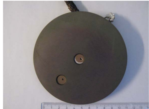
Abbildung 3-1: Aufbau einer Doppelsonde
