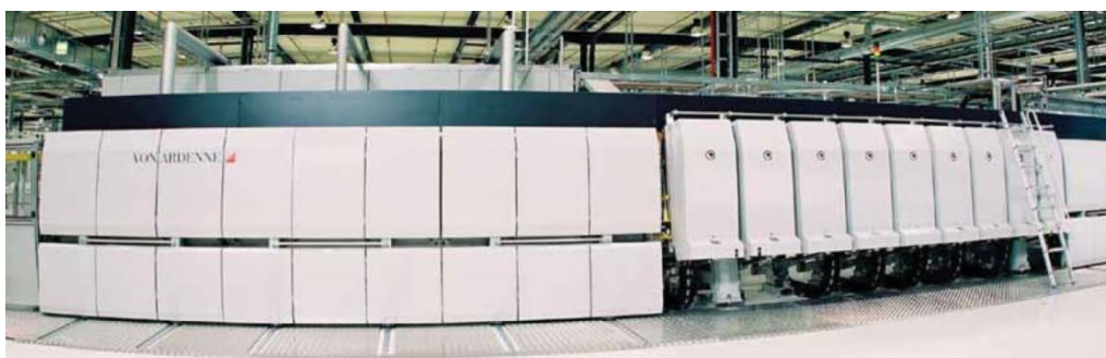
Abbildung 6-4: Vertikale Glas-Beschichtungsanlage/ PVD Durchlaufanlage GC 60 V, Version A [ARD06]
