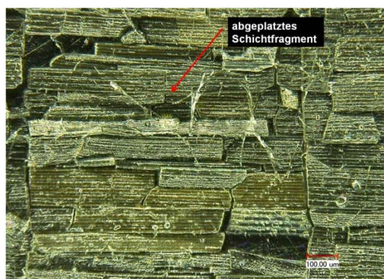
Abbildung 5-14: Lichtmikroskopaufnahme einer laserstrukturierten Schicht (10 µm breite Kanäle, 10 µm breite Stege, 50 Pulse, 1,0 J/cm 2 Energiedichte) nach 10 Zyklen mit C/20, 250 x Vergrößerung (Beschichtungsparameter: 10,0 % Sauerstoffgehalt im Arbeitsgas, 1,0 Pa Arbeitsgasdruck, -40 V HF-Substratvorspannung, 100 W Targetleistung, Edelstahlsubstrat)
