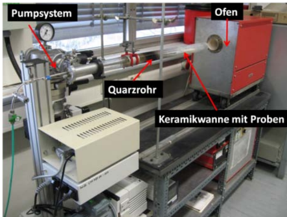
Abbildung 3-8: Temperofen mit Vakuumpumpensystem
