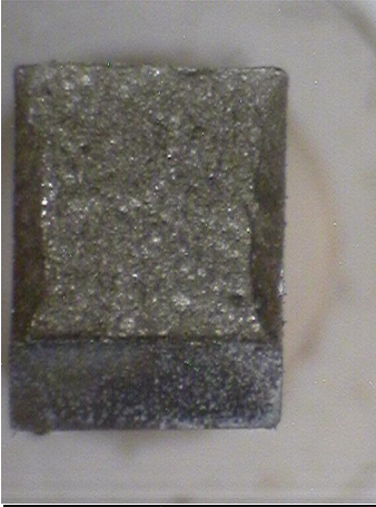
Fig. 8-37 Tested impact specimens EO 01, EO 02, EO 03, EO 04 after complete breaking (Macro)
