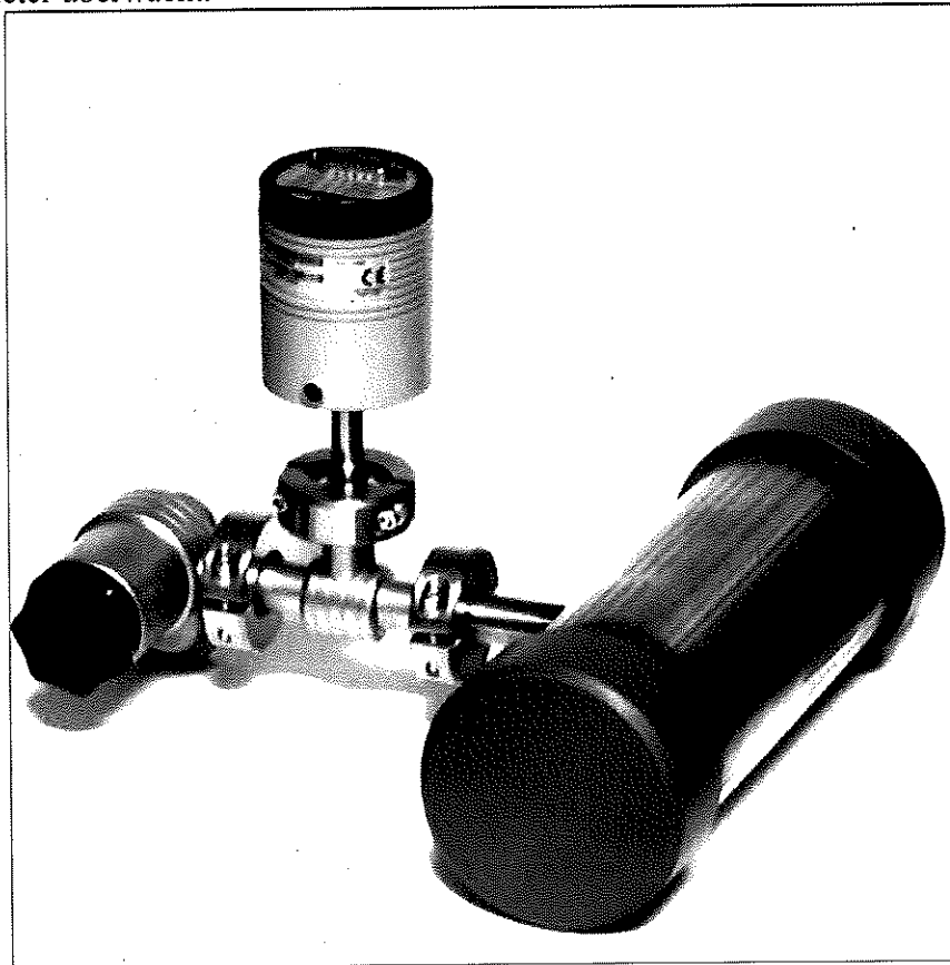
Abb. 5.8 : Gaszelle mit Manometer. Die Länge des Gasraums beträgt 200 mm, die freie Öffnung 70 mm. Der Strahlquerschnitt der Bruker Spektrometer beträgt 65 mm, so daß die Zellen in den Parallelstrahl vor das Spektrometer gestellt werden können. Die NaCl-Fenster sind geneigt und gekeilt, um Interferenzeffekte an den Zellenfenstern zu vermeiden (siehe Abschnitt 5.2).
