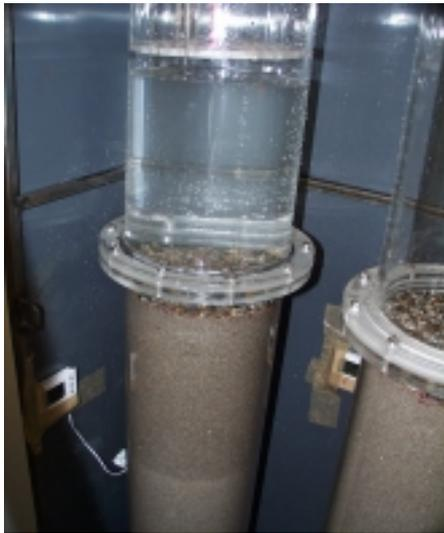
Bild 1: Sandfilter während einer Beschickung.
