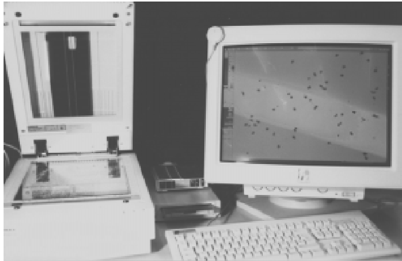
Abbildung 3–19: Flachbettscanner mit Durchlichtaufsatz (links, Deckel geöffnet) und Monitor des Bildanalyserechners.
