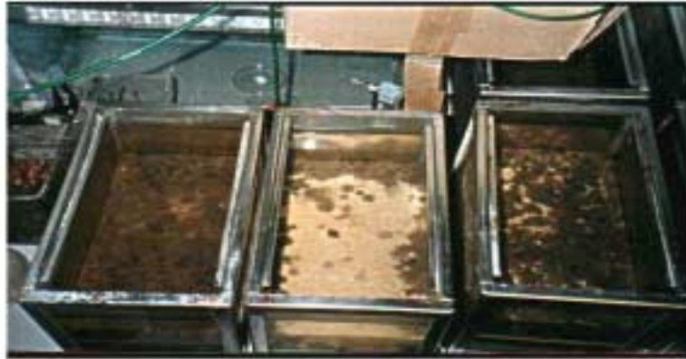
Abb. 3.1.1c: Vergleich der Intensität der Bioturbation in den Aquarien mit 1 cm (links), 2 cm (Mitte) und 2.5 cm (rechts) hohen Kalzitbarrieren vier Monate nach Aufbringung.
