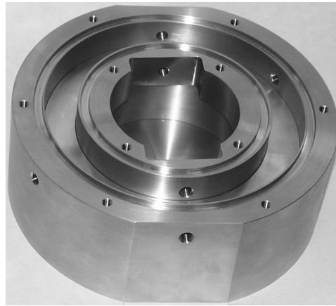
Abbildung 3.33: Konventionell beheizter Applikator zum Vergleich mit dem Mikrowellenreferenzapplikator. Quelle: Technische Chemie 1, Universität Erlangen.
