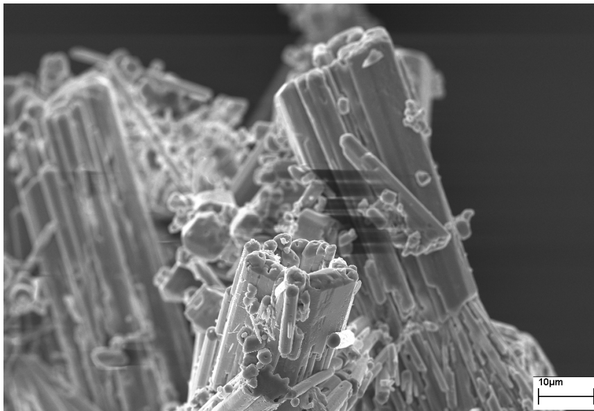
Abbildung 5.22: Rasterelektronenmikroskopaufnahme des dotierten Pulvers nach 30 Minuten Prozessierung mit Magnetfeld. Skala: 10\ \mu\text{m} . In der Mitte ist ein Ring deutlich zu erkennen.
