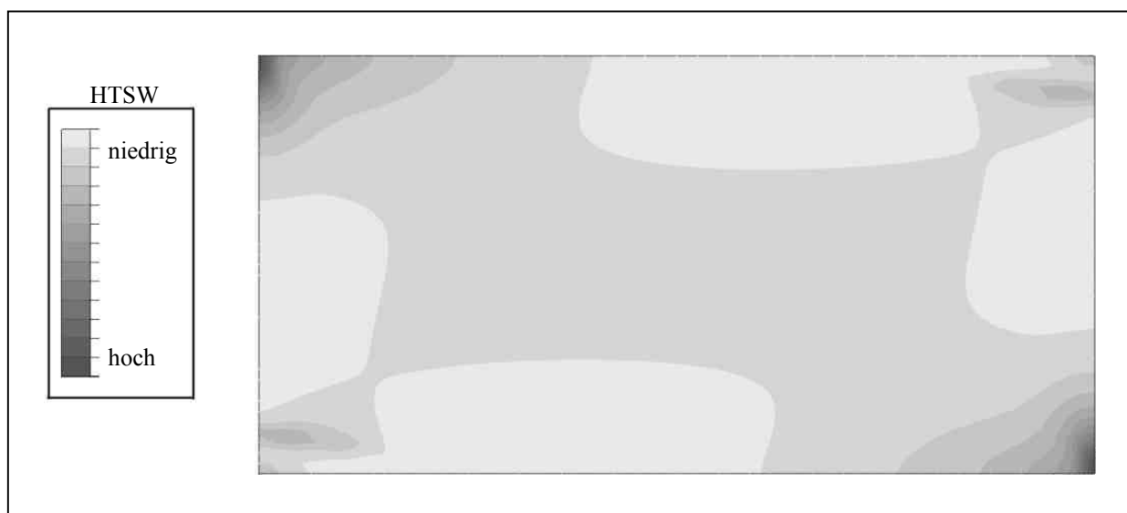
Abbildung 5.4: Verteilung des Hauptspannungs-Tsai-Hill-Wertes (HTSW) am gewählten Beispiel
