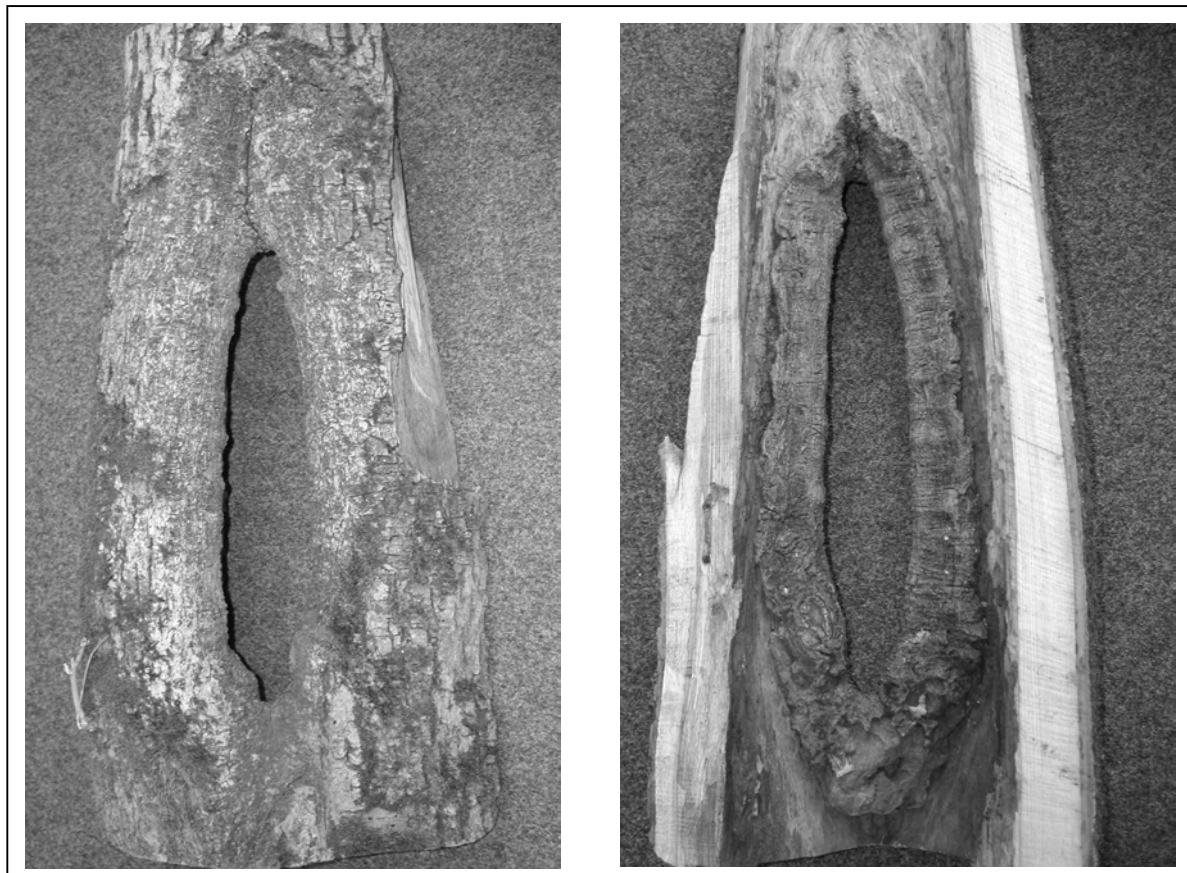
Abbildung 5.6: Wundholzbildung an der offenen Morschung einer Fichte. Außen mit optimalem Faserverlauf (links), innen deutlich erkennbares Pflaster über bereits vorhandenem und deshalb für die Öffnung nicht optimalem axialem Faserverlauf (rechts)
