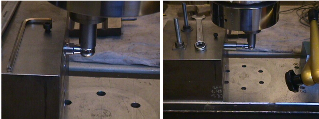
Bild 2.11: Hebelarme bei den Querkraftversuchen 2
