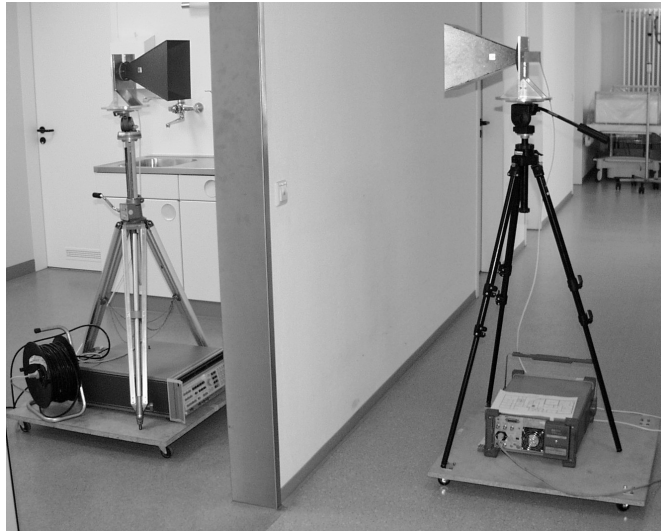
Bild 3.9 Messaufbau zur Bestimmung der reinen Wanddämpfung mit zwei Hornantennen (Kranken­zimmer, 5,2 GHz)
