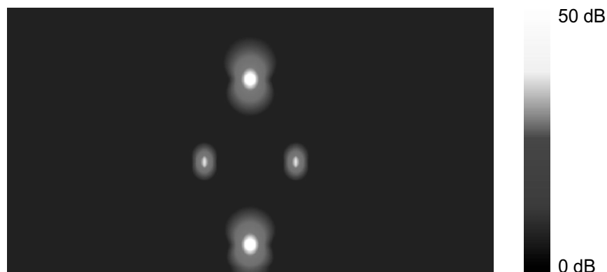
Bild 7.10 Feldstärkeverteilung in der Trennwand zwischen MRT-Raum und benachbartem Behandlungsraum für 42,6 MHz, v-Polarisation
