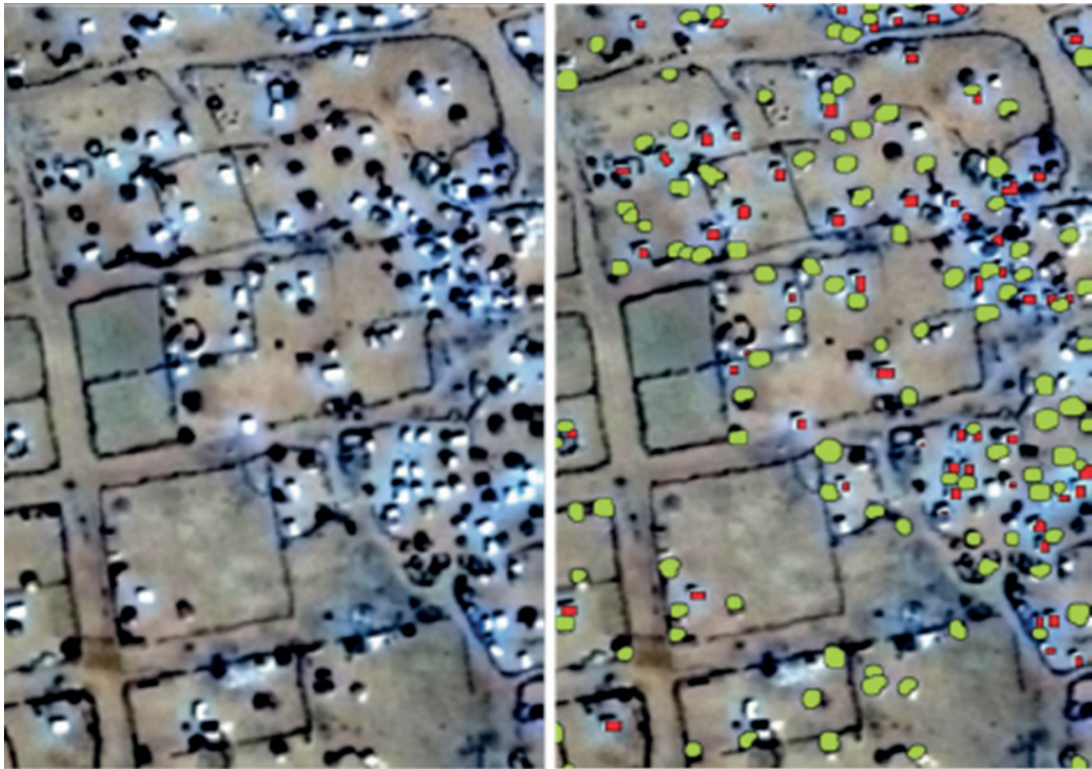
ABB. II.10 OBJEKTBASIERTE KLASSIFIKATION: ANWENDUNGSBEISPIEL IDENTIFIKATION DER BEHAUSUNGEN EINES FLÜCHTLINGSLAGERS IN DARFUR
