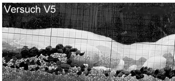
Abb. 2.46 Vergleich der Schicht aus Zugabematerial der Versuche V5 ( g_{zu} = 5 kg/m·min, T = 480 min) und V7 ( g_{zu} = 40 kg/m·min, T = 60 min) (Zugabematerial dunkel eingefärbt)
