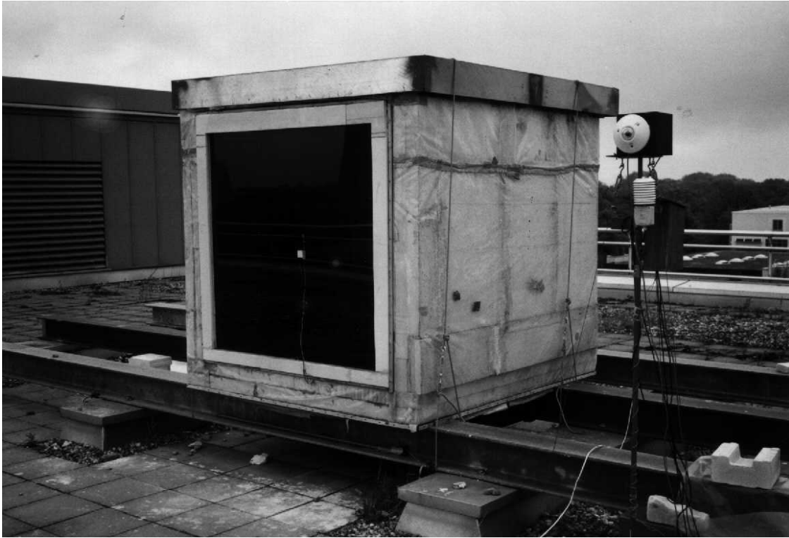
Bild 31: Testzelle mit Wetterstation (Foto)
