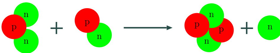
Abbildung 1.1.: Tritium und Deuterium fusionieren zu einem Alphateilchen und einem Neutron.
