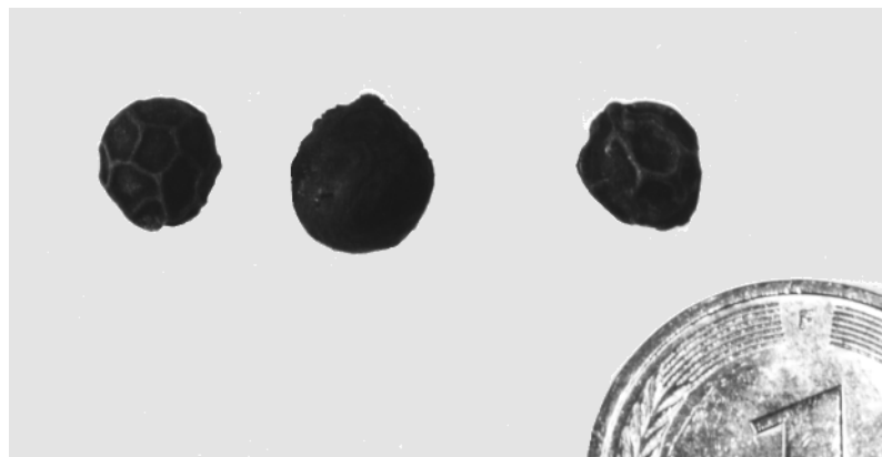
Abb. 4-31: Vergleich von in ruhender Luft und in flüssigem Stickstoff abgekühlten Pfeffer (links: unbehandelte Pfeffer; Mitte: in ruhender Luft abgekühlter Pfeffer; rechts: in flüssigem Stickstoff abgekühlter Pfeffer). Die Behandlungszeit beträgt 2 s, das verwendete Gas ist Stickstoff bei einer Temperatur von 560 °C und einem Kaltgasvolumenstrom von 3 m 3 /h.
