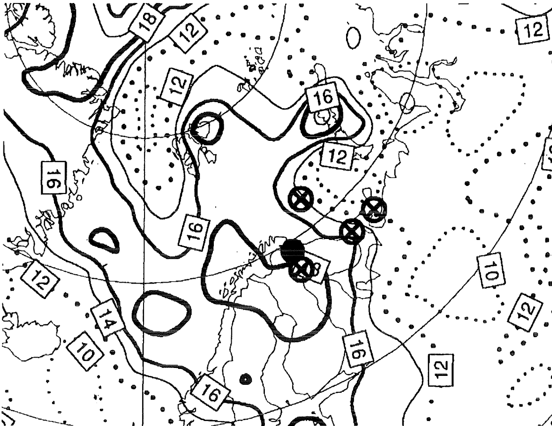
Abbildung 31. Potentielle Wirbelstärke über Nordeuropa am 15. März 1992. Dargestellt sind die Niveaulinien der potentiellen Wirbelstärke auf der 400 K Fläche der potentiellen Temperatur. Die geographische Lage der MIPAS-B-Messung (ausgefüllter Kreis) und der CLAES-Messungen (Kreuze) sind ebenfalls eingezeichnet.
