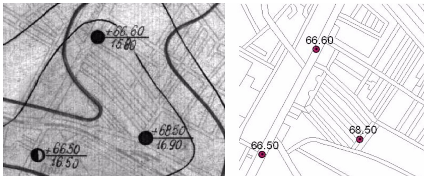
Abb. 5-2: Analoge (links) und digitale (rechts) Darstellung desselben Kartenausschnitts. Die in einer Attributtabelle abgelegten Sachdaten der Punktcoverage (in diesem Fall Höhenwerte einer Schichttyp-Oberfläche) können als Labelbeschriftung angezeigt werden.
