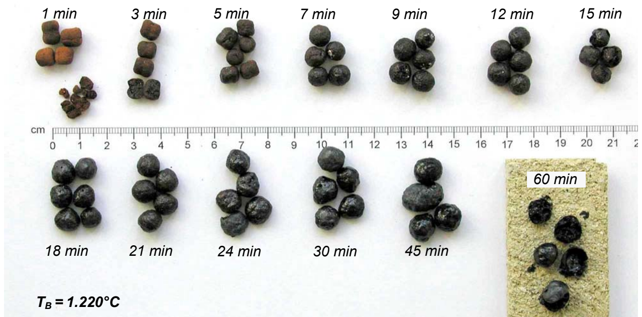
Bild 6-20: Auswirkung der Brennzeit
