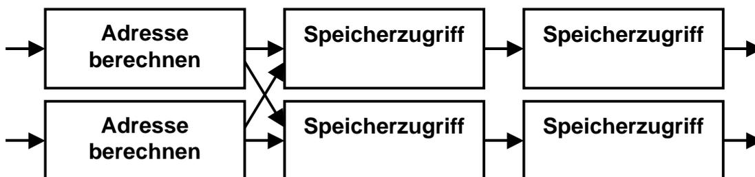
Abbildung 6-5: Pipeline der Lade-/Speichereinheit für internen Speicher, bei der Verwendung von zwei Einheiten
