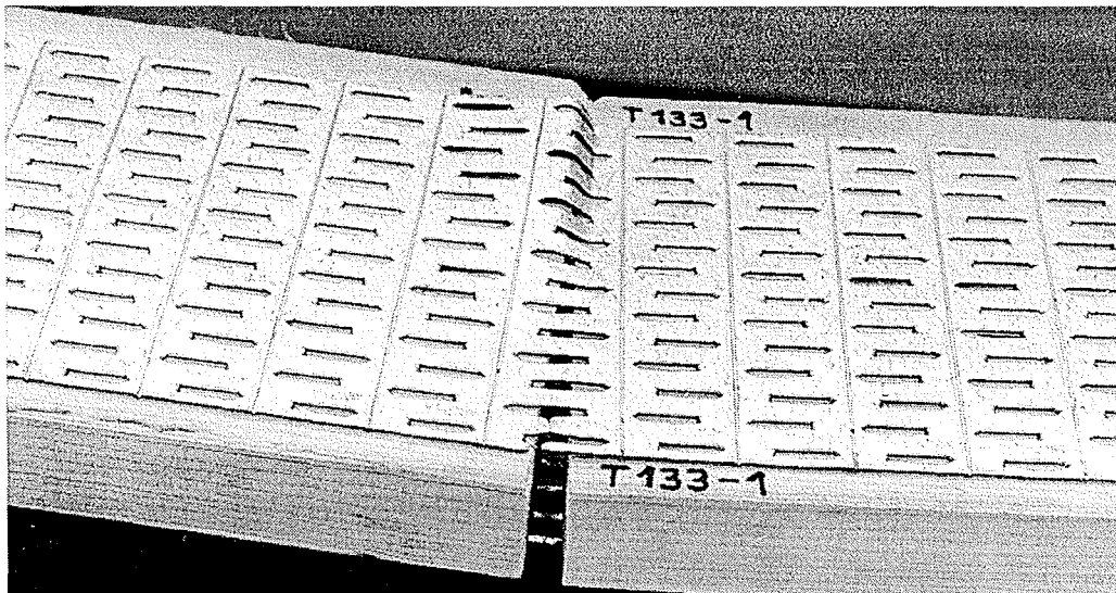
Abb. E-66: Typisches Bruchbild der Reihe T133
