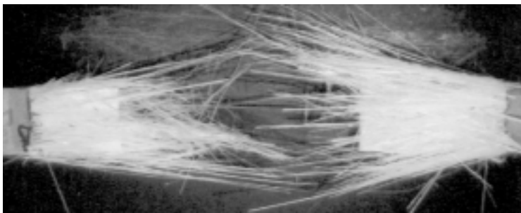
Abbildung 5.17: Bruchbild von GF/EP 0/90° unter quasistatischer Zugbelastung bei 77 K
