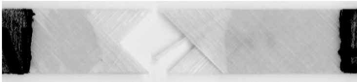
Abbildung 5.21: Bruchbild von GF/EP \pm 45^\circ unter quasi-statischer Zugbelastung bei 77 K
