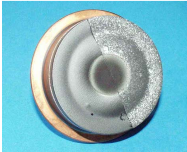
Abbildung 3.2: Photo des segmentierten Targets C/TiC(70/30)-C, Durchmesser des Targets: 75 mm
