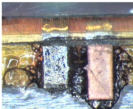
Abbildung 4.21: Beschädigung der Kunststoffbauteile durch anisotropes Kleben.
