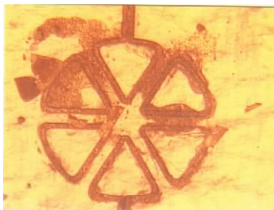
Abbildung 4.1: Wegen der Instabilität der Lackschicht beschädigte Mikrostruktur.
