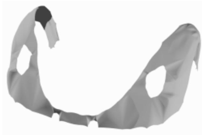
Abbildung 5.10: Kotflügel eines VW-Käfers, durch einen Quadrikspline interpoliert.
