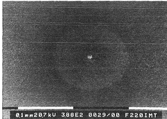
Abb.25b: Aluminiumschicht auf einer Titanmembran. Im Zentrum einer Blase befindet sich die geätzte Öffnung nach Abb.25a.
