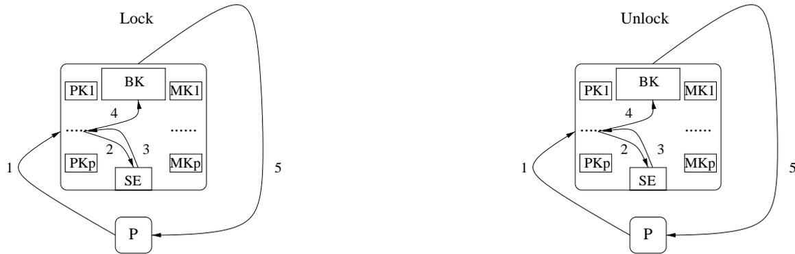
Abbildung 7.21: Der Ablauf der Kommunikation bei Lock- und Unlock-Operationen bei der on-Chip Synchronisation.
