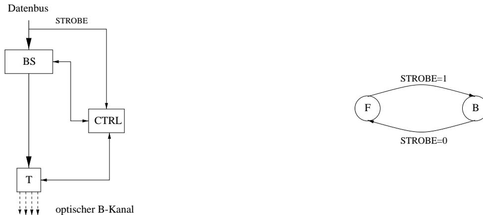
Abbildung 7.14: Der Aufbau (links) und das Zustandsübergangsdiagramm (rechts) der TE.
