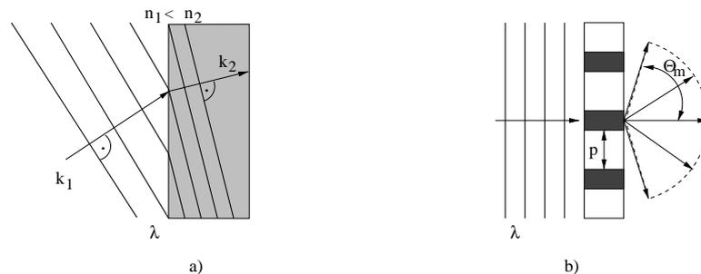
Abbildung 4.6: Der Einfluß verschiedener optischer Elemente auf eine ebene Welle. Bild a) zeigt Brechung an der Grenzfläche zwischen zwei Medien mit unterschiedlichen Brechungsindizes. Es entspricht der Brechung eines parallelen Strahlenbündels. Im Bild b) ist die Brechung durch Graustufen bzw. Phasenmuster zu sehen.
