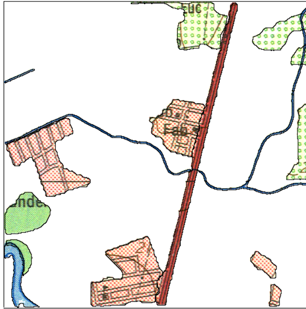
Abbildung 42: Ergebnis der Segmentierung von Farbschichten nach dem Umfang der Dreiecke in der Delaunay-Triangulation.
