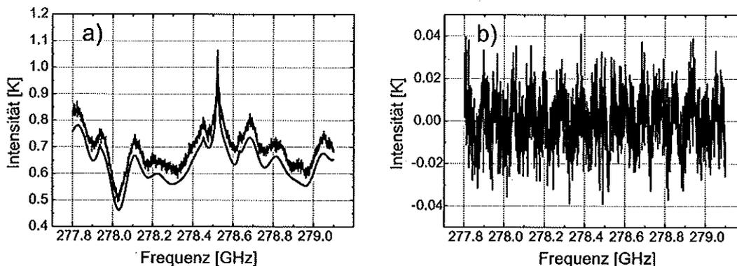
**Abb. 6.15:** (a) Synthetisches ClO-Spektrum mit stehenden Wellen, Rauschen und Frequenzshift. Die glatte Linie ist das Ergebnis der Inversionsrechnung mit Anpassung der stehenden Wellen
