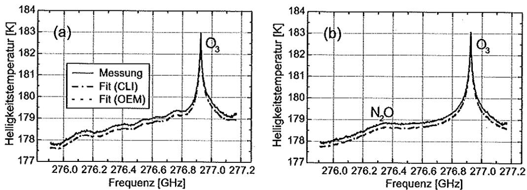
Abb. 6.17: Am 31. März 1996 gemessenes  $\text{N}_2\text{O}$ -Spektrum und angepaßte Spektren vor (a) und nach (b) der Korrektur um sieben Stehwellen
