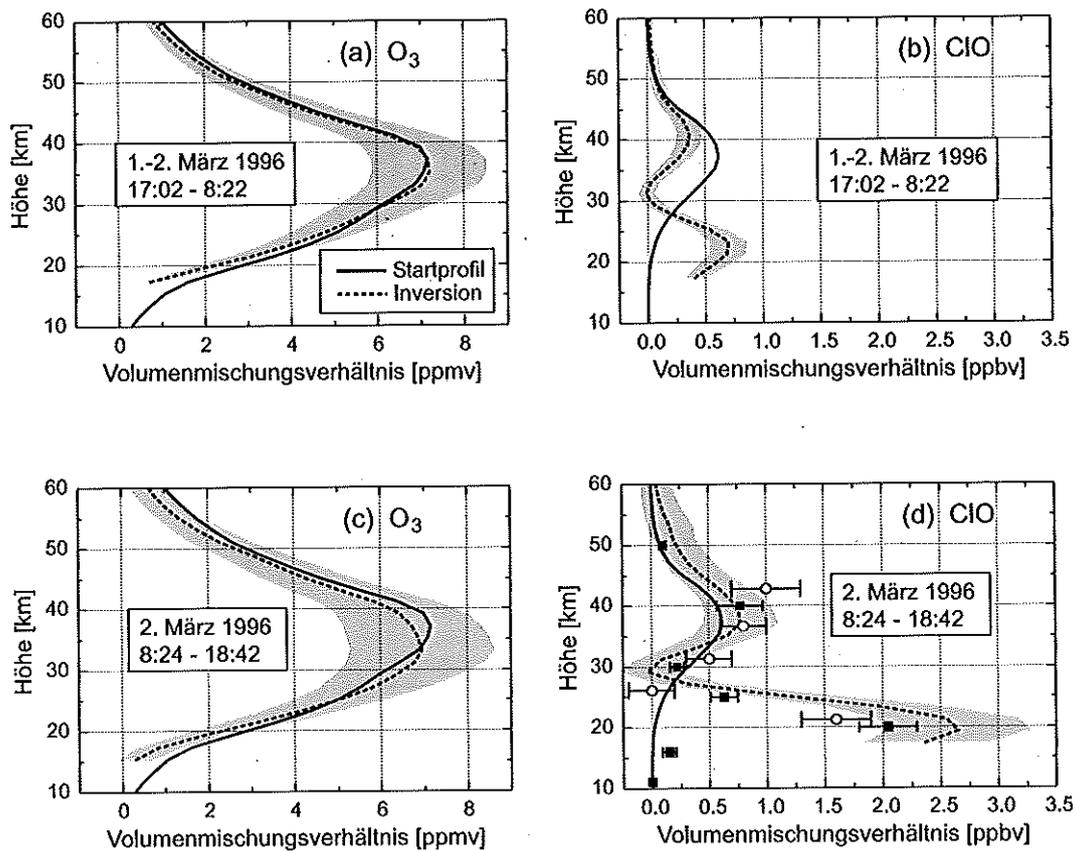
**Abb. 6.12:** Aus den in Abbildung 6.11 gezeigten Spektren invertierte Höhenprofile von Ozon ((a) und (c)) und ClO ((b) und (d)). In (d) sind zusätzlich noch Meßwerte des flugzeuggetragenen Submillimeterwellenradiometers ASUR (ausgefüllte Quadrate) und des Microwave Limb Sounders (Kreise) eingezeichnet
