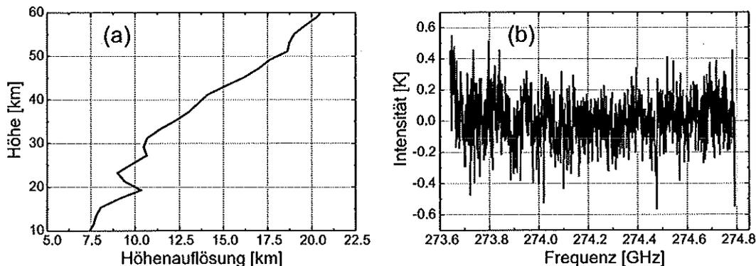
Abb. 6.10: Höhenauflösung (a) und Residuum (b) der Ozonmessung an der 274,478 GHz-Linie
