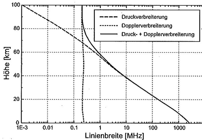
Abb. 3.2: Druck- und Dopplerverbreiterung der ClO-Liniengruppe bei 278,631 GHz, berechnet für die US Standardatmosphäre für mittlere Breiten
