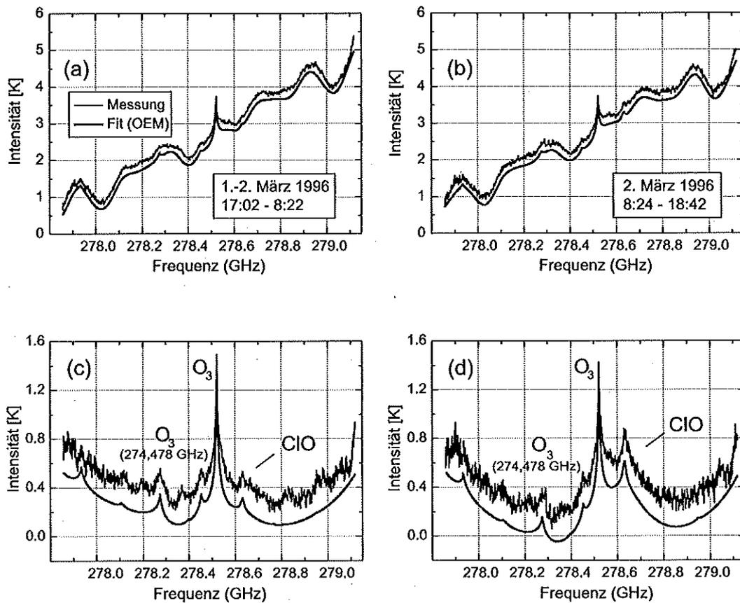
**Abb. 6.11:** ClO-Messungen vom 1. und 2. März 1996. In (a) ist das unkorrigierte Spektrum der Nachtmessung und in (b) das der Tagesmessung gezeigt. Nach der Korrektur um Stehwellen und Hang ergeben sich die in (c) und (d) dargestellten Spektren. Der besseren Übersicht wegen wurden die angepaßten Spektren etwas gegen die gemessenen vertikal verschoben
