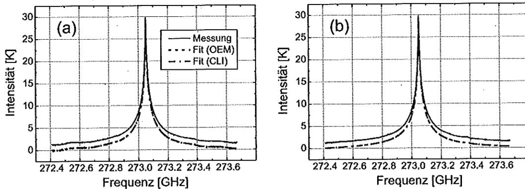
Abb. 6.5: Am 29. März 1996 bei 273,051 GHz gemessenes Ozonspektrum vor (a) und nach (b) der Korrektur um drei Stehwellen. Der besseren Übersicht wegen wurden die vorwärts gerechneten Spektren gegen die Messung vertikal etwas verschoben
