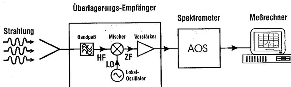
Abb. 4.1: Funktionseinheiten eines Radiometers
