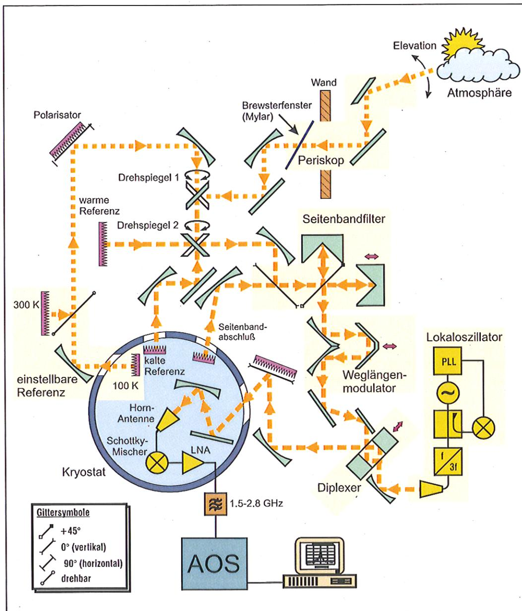
Abb. 4.4: Schematischer Aufbau des 268–280 GHz Radiometers MIRA 2 (Stand 1999)
