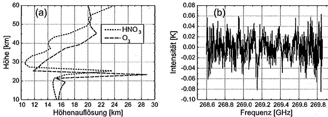
Abb. 6.24: Höhenauflösung (a) und Residuum (b) der HNO<sub>3</sub>-Messung vom 20. März
