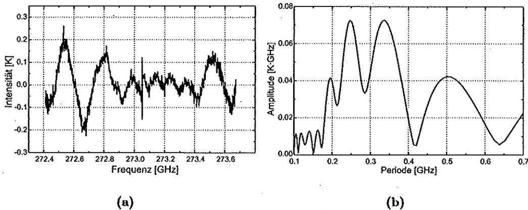
Abb. 5.1: (a) Residuum einer Ozonmessung bei 273,051 GHz
