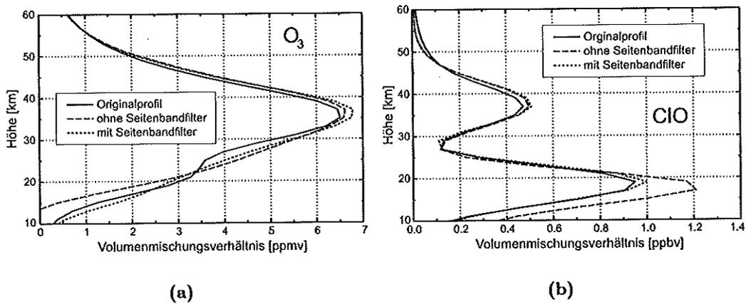
**Abb. 5.5:** Auswirkungen der Troposphärenkorrektur mit und ohne Berücksichtigung der Seitenbandfiltercharakteristik auf das Inversionsergebnis. Die Schaubilder zeigen die Ergebnisse der Inversion der in Abbildung 5.4(a) gezeigten Spektren. Schaubild (a) zeigt die invertierten Ozonprofile, Schaubild (b) die invertierten ClO-Profile
