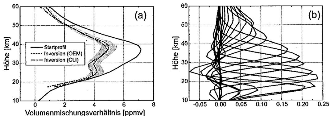
**Abb. 6.9:** (a) Mit der Optimal Estimation Methode bzw. Tikhonov-Phillips-Regularisierung invertierte Ozonprofile vom 19. Februar 1996
