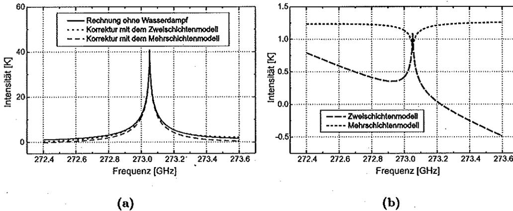
**Abb. 5.2:** (a) Vergleich der Troposphärenkorrektur mittels Zweischichten- und Mehrschichtenmodell, exemplarisch für die Ozonlinie bei 273,051 GHz
