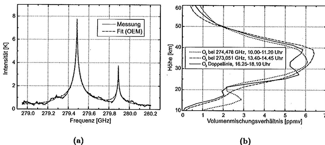
**Abb. 6.56:** Messung an der Ozon-Doppellinie bei 279,485 GHz und 279,892 GHz. In (a) ist ein am 6. März 2000 gemessenes Spektrum abgebildet. In (b) das daraus invertierte Höhenprofil im Vergleich mit Ozonmessungen an anderen Linien vom gleichen Tag
