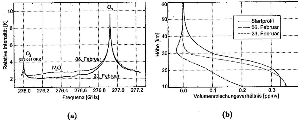
Abb. 6.32:  $N_2O$ -Messungen vom 6. und 23. Februar 1998. Die in (a) gezeigten Spektren sind noch nicht um stehende Wellen korrigiert. Abbildung (b) zeigt die daraus mit der Optimal Estimation Methode invertierten Spektren
