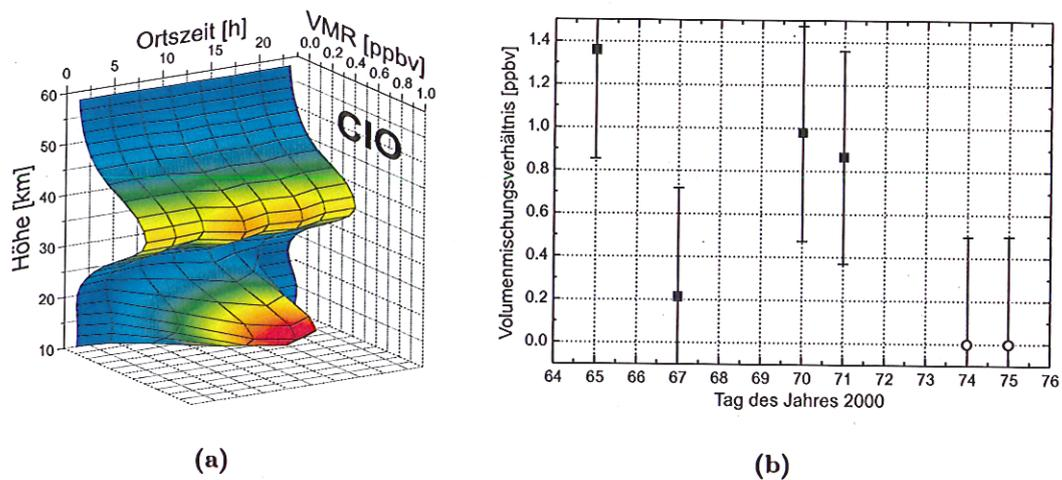
**Abb. 6.52:** CIO-Messungen in Phase 3. In (a) ist der Tagesgang vom 11. März dargestellt, (b) zeigt die an den einzelnen Tagen um die Mittagszeit gemessenen Volumenmischungsverhältnisse des unteren Maximums (gefüllte Quadrate). Am 14. und 15. März (Tag 74 und 75) konnten keine Anzeichen für Chloraktivierung gefunden werden, was durch die offenen Kreise bei 0 ppbv symbolisiert wird. Mit eingezeichnet sind die geschätzten Gesamtfehler
