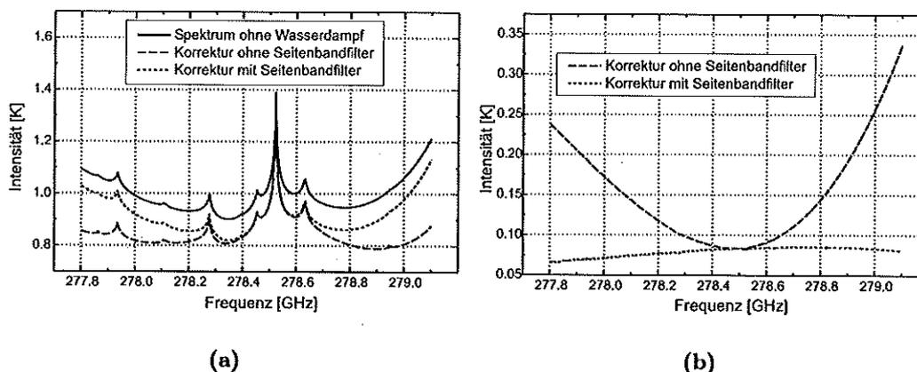
**Abb. 5.4:** (a) Vergleich der Troposphärenkorrektur unter Berücksichtigung der Filtercharakteristik des Seitenbandfilters mit der ohne diese Berücksichtigung. Zum Vergleich ist noch ein Spektrum, das ganz ohne Wasserdampf berechnet wurde, gezeigt.
