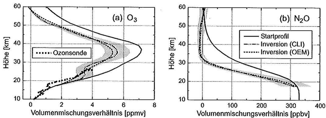
Abb. 6.18: Profile von Ozon (a) und  $\text{N}_2\text{O}$  (b) vom 31. März 1996, gewonnen durch gleichzeitige Inversion. In (a) sind noch zum Vergleich die Ergebnisse eines Ozonsondenaufstiegs vom 30. März 1996 eingezeichnet
