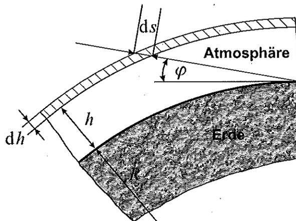
Abb. 3.4: Beobachtung der Erdatmosphäre unter flachem Elevationswinkel
