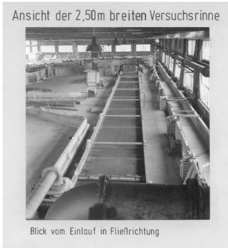
Abbildung 5-1: Versuchsstand der BAW mit eingebauten Modellbuhnen
