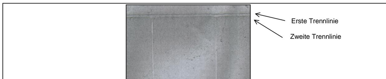
Abb. 5.2: 3 µm dicke PC-Folie geschweißt auf PMMA Substrat
