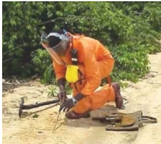
Bild 1.1 Nach wie vor werden bei der Minensuche neben Metalldetektoren vor allem Stocherstäbe eingesetzt, eine extrem gefährliche und zeitraubende Technik.
