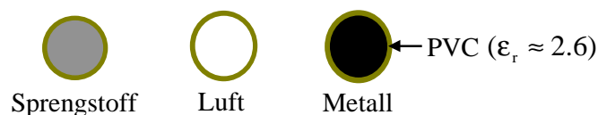
Bild 5.1 Modellierte Kugelobjekte. Der Durchmesser aller Kugeln beträgt 10 cm, die Dicke der PVC-Hülle jeweils 5 mm.
