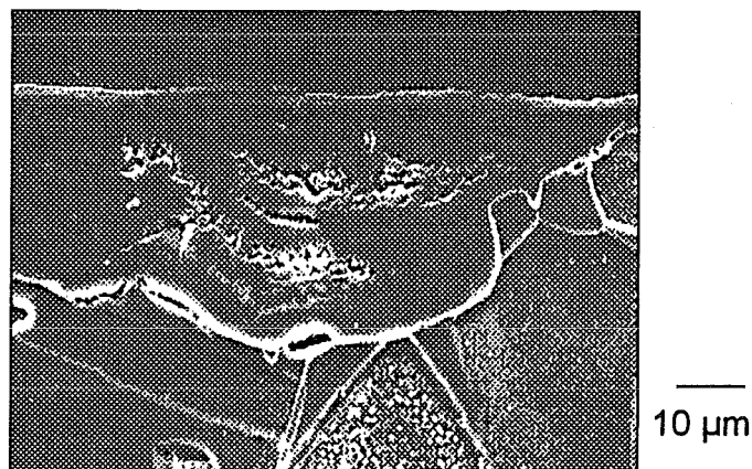
Abbildung 36: Querschliff von Avesta 654 SMO (420°C, 400 bar, 24 h, 4000 ppm Cl - )
