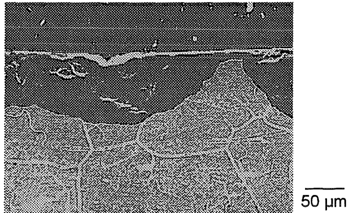
Abbildung 100: Hastelloy G-30 (100 h vorox.) nach 160 h Auslagerung ( 420^\circ\text{C} , 400 bar, 4000 \text{ ppm Cl}^- )
