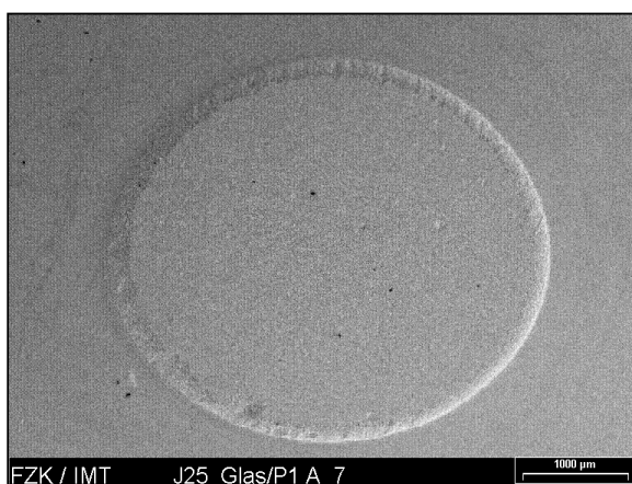
Abbildung 3.1 REM-Aufnahme einer mittels Flusssäure aus einem 50µm dicken Glassubstrat herausgeätzte kreisförmigen Glasplatte, Ø 4mm
