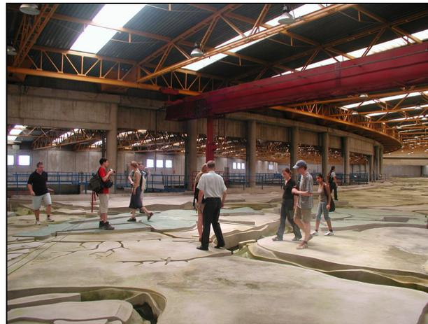
*Die Lagune von Venedig als hydraulisches Modell im Versuchszentrum Voltabarozzo (Padua), in welchem auch Modelle des MOSE-Systems zum Hochwasserschutz betrieben werden.*
