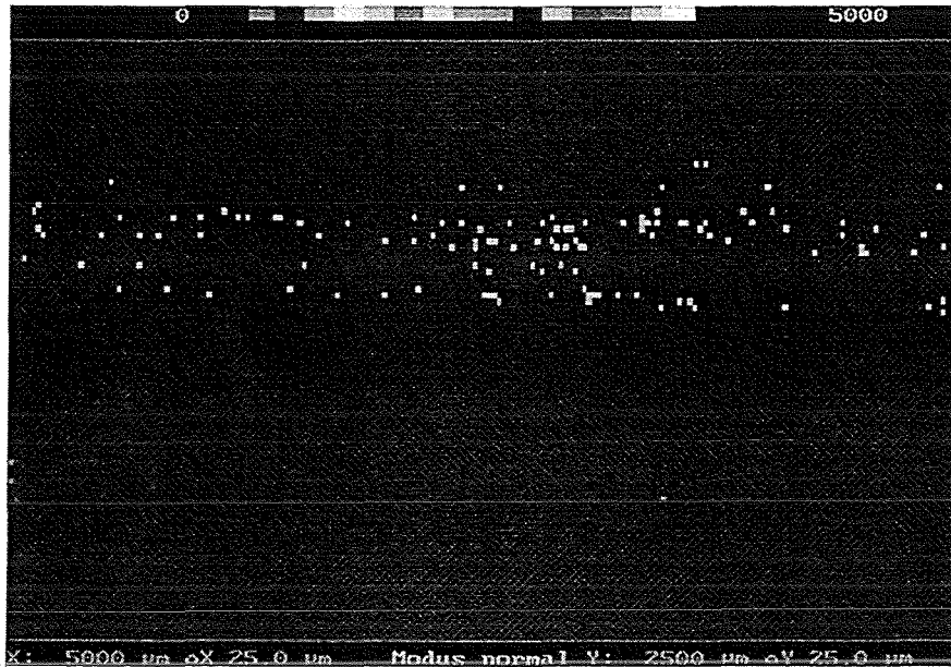
Abb. 5.29: Photothermisches Bild (Amplitude) eines Antlerit/Brochantitpellets bei \lambda = 9,52 \mu\text{m} , f = 800 \text{ Hz} , h = 200 \mu\text{m} ; (Antlerit : links ; Brochantit : rechts)
