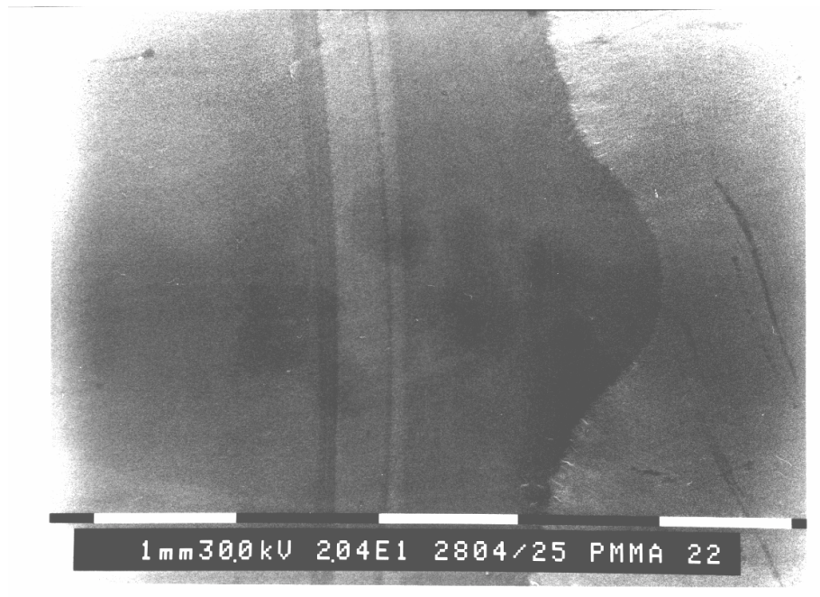
Abbildung 6.4: REM-Aufnahme einer Bruchfläche PMMA bei 20-facher Vergrößerung. Ein Abschnitt des schwarz-weißen Balkens entspricht 1 mm. Rechts ist deutlich die 'D'-frmige Arrestlinie zu sehen.
