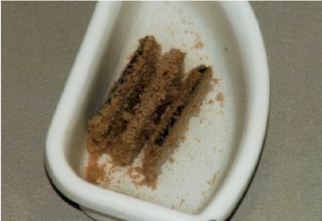
Abbildung A.9. Oberstes von 4 Festbettelementen aus der Denitrifikation von ECM-Abwasser mit Methanol am 128. Betriebstag (Kap. 3.1.4).
