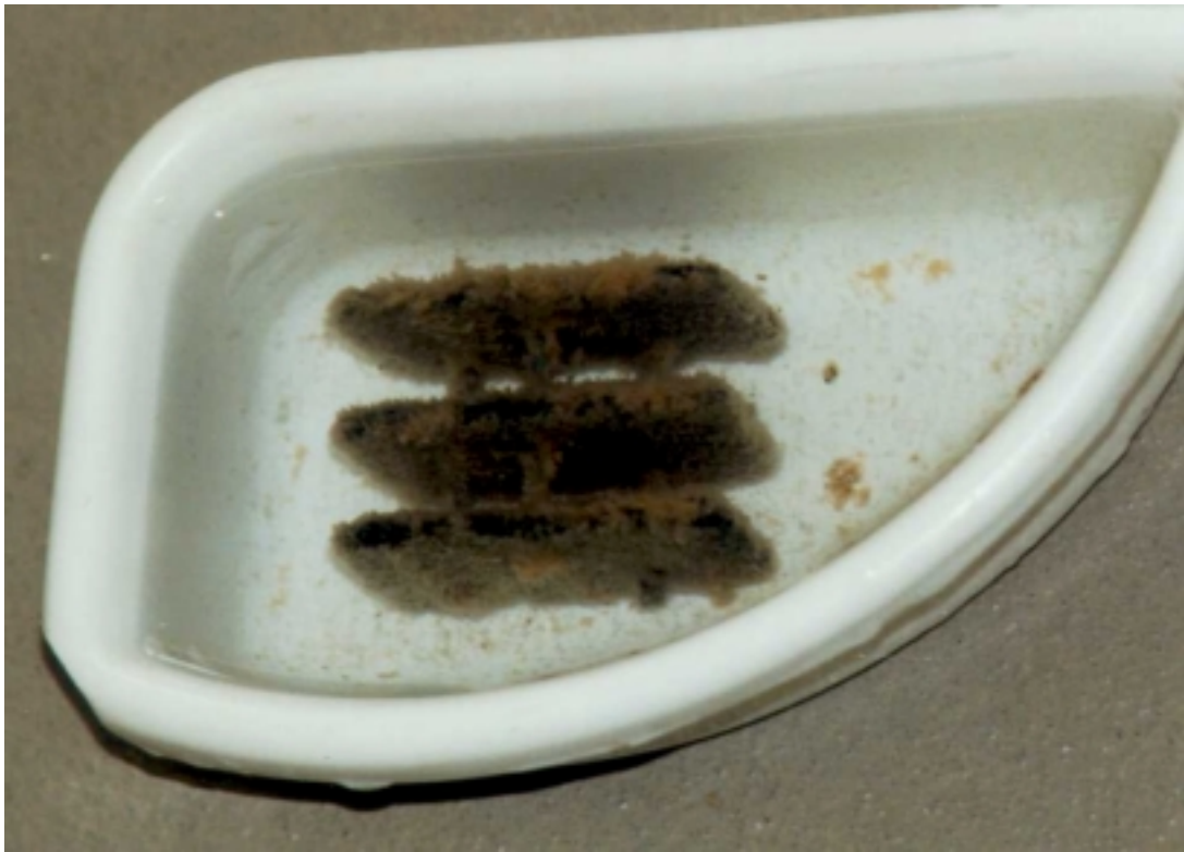
Abbildung A.13. Oberstes von 4 Festbettelementen aus der aeroben Nachbehandlung von Permeat P-22 mit Aktivkohle-Festbett nach 51 Tagen Betriebszeit (Kap. 3.4.3.2).
