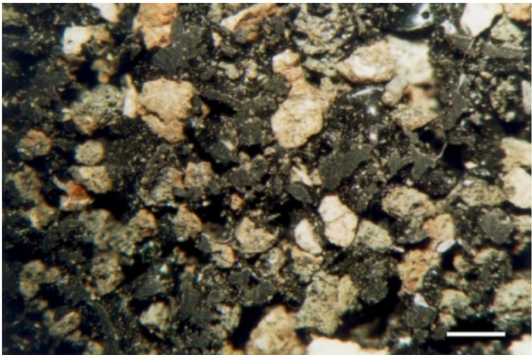
Abbildung A.2. Festbettmaterial „Pelias“; Blähton-Sinter-Platten (Balken = 1 mm).
