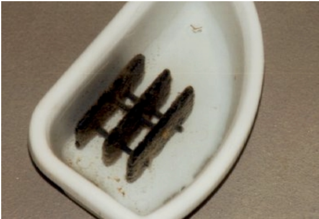
Abbildung A.19. Oberstes von 4 Festbettelementen aus der aeroben Nachbehandlung von Permeat MB40 mit Aktivkohle-Festbett nach 14 Tagen Einsatz (Kap. 3.4.3.3).
