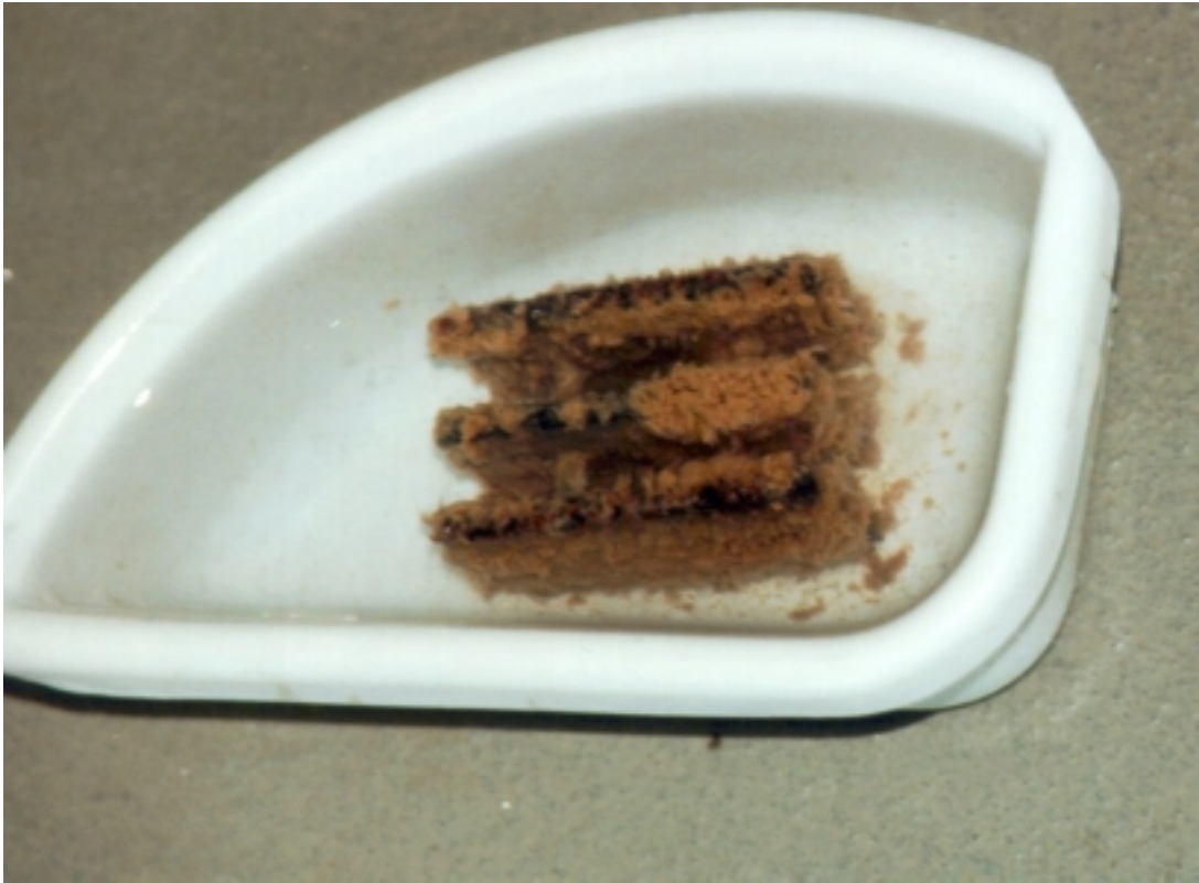
Abbildung A.11. Oberstes von 4 Festbettelementen aus der Denitrifikation von Permeat P-22 mit \text{NaNO}_3 am 133. Betriebstag (Kap. 3.2.1.2).
