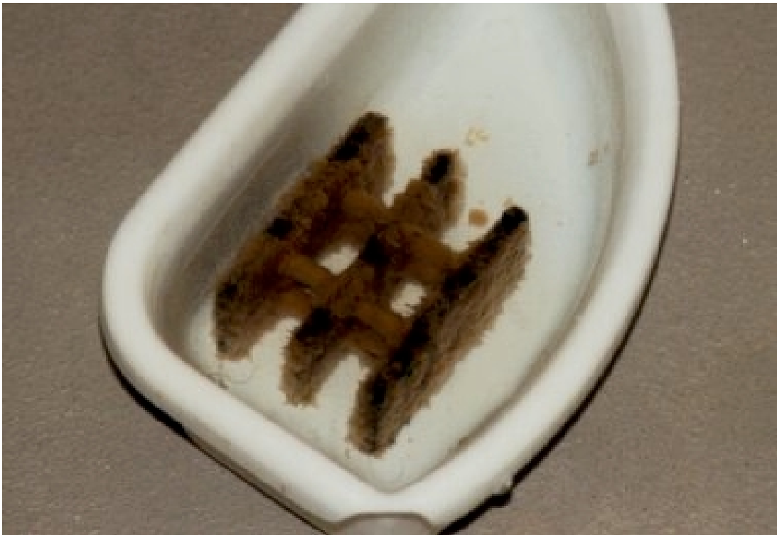
Abbildung A.17. Oberstes von 4 Festbettelementen aus der aeroben Nachbehandlung von Permeat MB40 mit Pelia-Festbett am 228. Betriebstag (Kap. 3.2.2.3).
