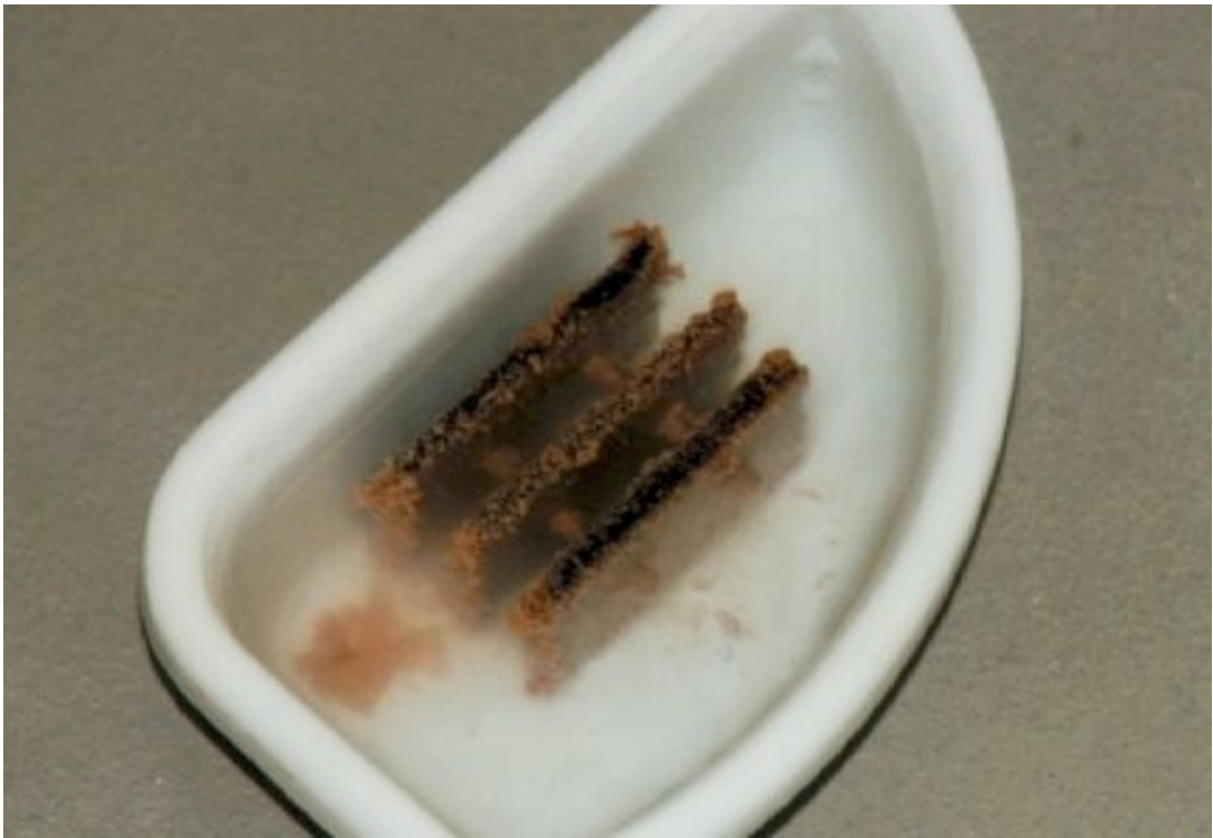
Abbildung A.7. Oberstes von 4 Festbettelementen aus der Denitrifikation von ECM-Abwasser mit Essigsäure am 128. Betriebstag (Kap. 3.1.4).
