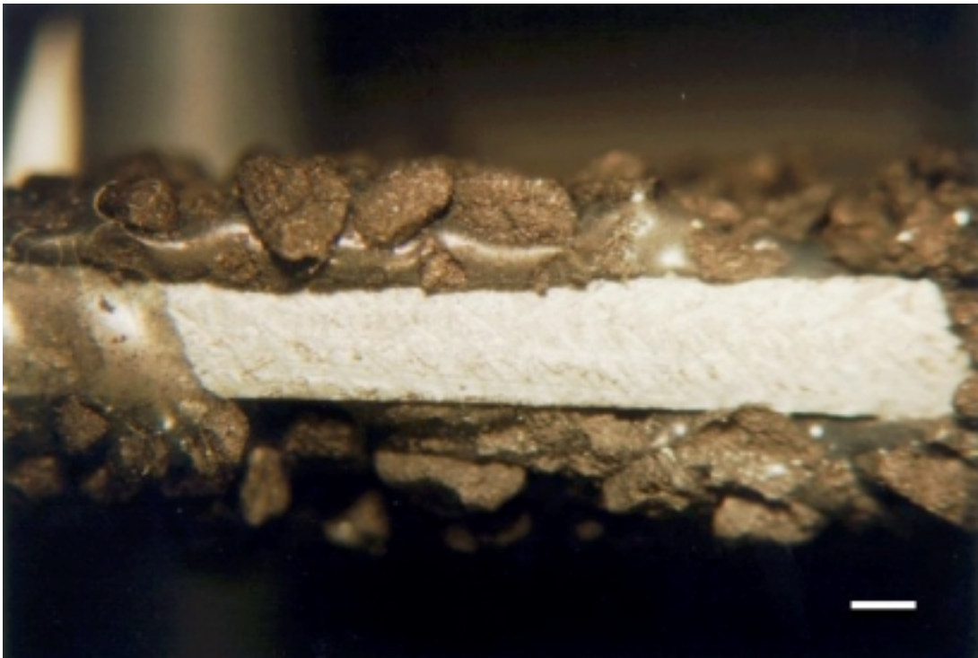
Abbildung A.3. Festbettmaterial „AK F400“; Festbett-Elemente aus PU-Platten (mitte) der Kantenlänge 5 x 7 cm, auf denen die Aktivkohle F400 mittels Heißkleber fixiert wurde (oben und unten); Balken = 1 mm.
