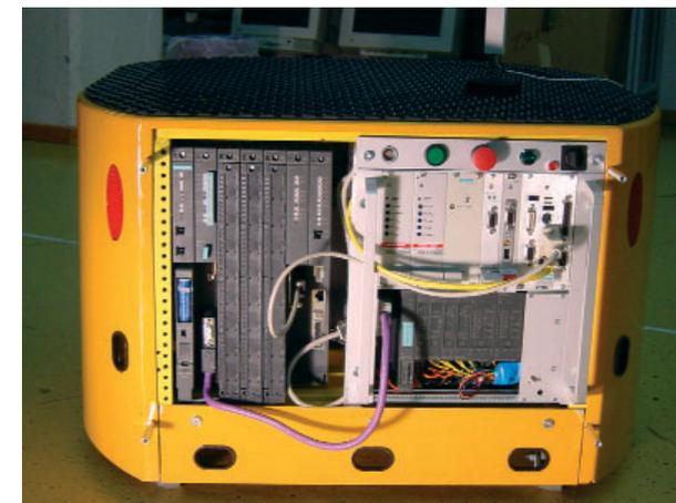
Mobiler Roboter mit Simatic-Komponenten
