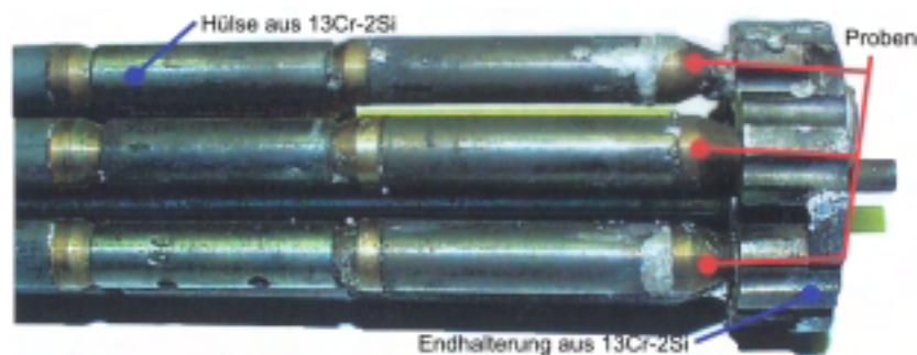
Abb. 6-19: Endstück der Probenhalterung von IPPE nach 2000 h Auslagerung bei 600°C
