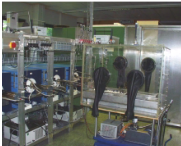
Abb. 6-11: Handschuhbox für Probenwechsel
