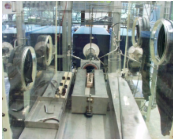
Abb. 6-13: Innenraum der Handschuhbox mit einem gefüllten Probenträger in der Mitte des Bildes und Aluminiumtiegel für die gewechselten Proben links im Bild
