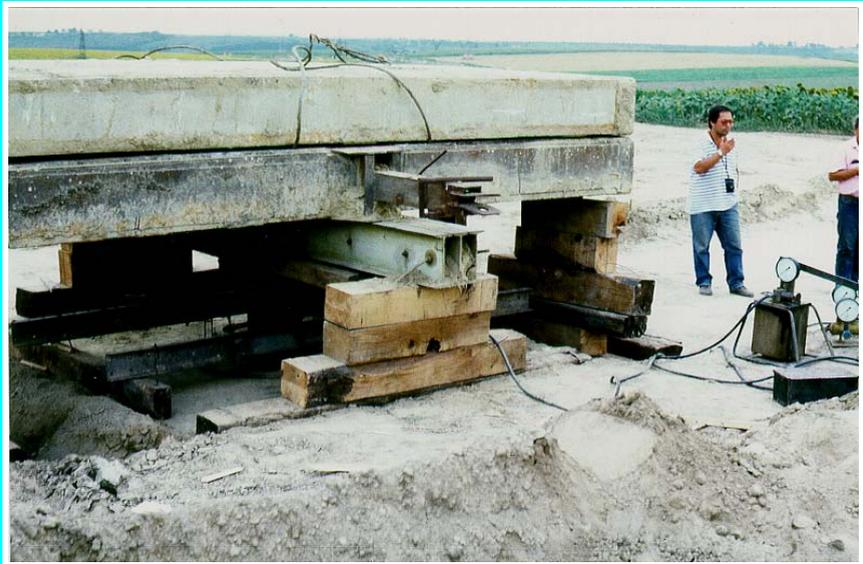
*Abb. 39: Plattendruckversuchsanlage mit hydraulischer Pumpe und Gegengewicht (20 t)*
