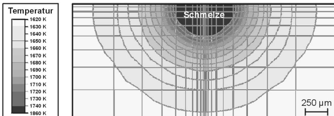
**Bild 4.14:** FEM-Simulation des Temperaturprofils während des Laseroberflächenumschmelzens von Cordierit ( $P_L$  (TRUMPF)  $\sim 70$  W,  $v_L = 1000$  mm/min,  $T_P = 1350^\circ\text{C} = 1623$  K).
