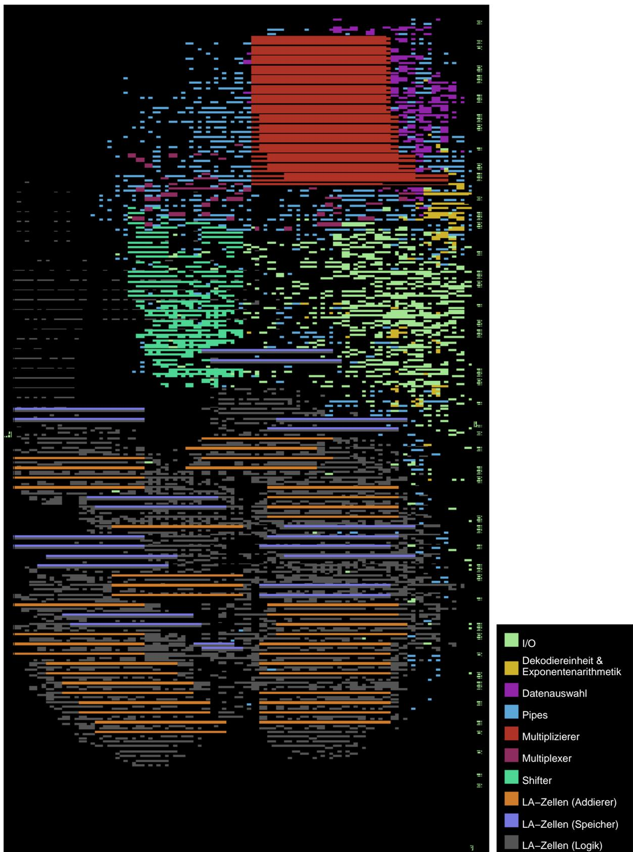
Abbildung 5.1: Gesamter Entwurf in einem XCV800
