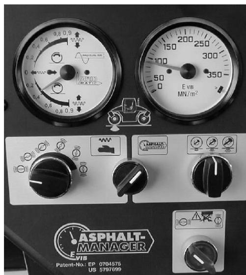
Abb. 3.7: Anzeige-Instrumente des Bomag Asphalt-Managers [Bomag 03]
