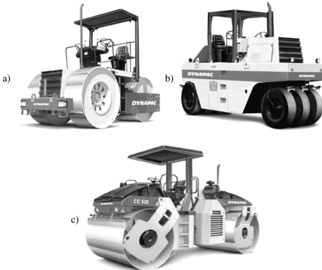
*Abb. 2.3: Typen von Walzen zur Asphaltverdichtung [Dynapac 03]
