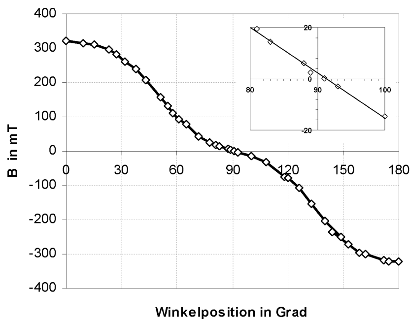
Abb. 3-10: Gemessene Flussdichte im Zentrum des Luftspalts in Abhängigkeit der Winkelstellung des Zylinders. Die maximale Flussdichte beträgt 322 mT und ist damit über 1200 mal so hoch wie die minimal gemessene Flussdichte. Die eingesetzte Grafik vergrößert den Bereich um 90°.
