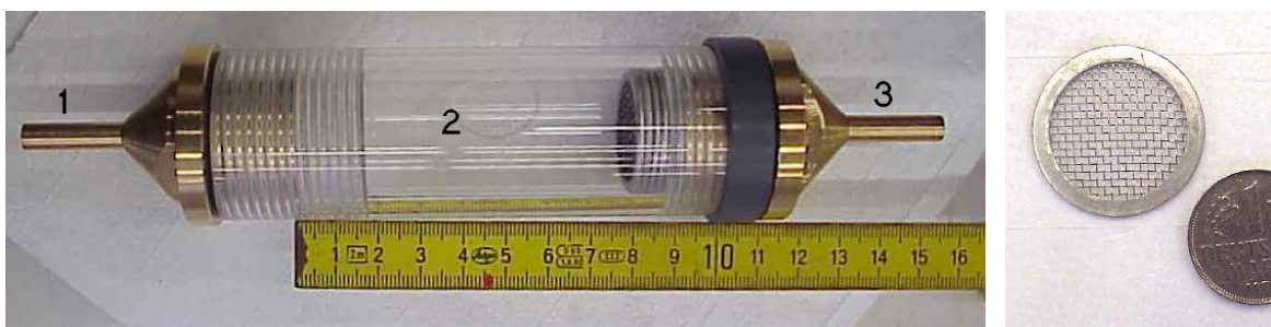
Abb. 3-3: (links) Separator mit Matricelementen., hier nur zum Teil gefüllt; 1. Zulaufstutzen, 2. Innenraum mit Filterelementen, 3. Ablaufstutzen. (rechts) Filterrunde
