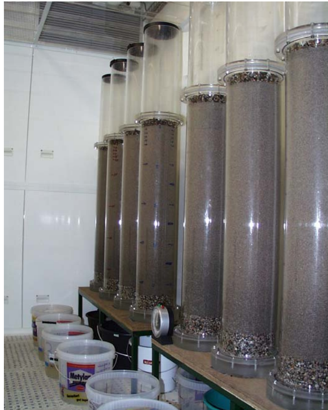
Abb. 7: Sandsäulen in der Klimakammer. Die untere und die obere Kiesschicht dienen dem Schutz der Sandschicht.
