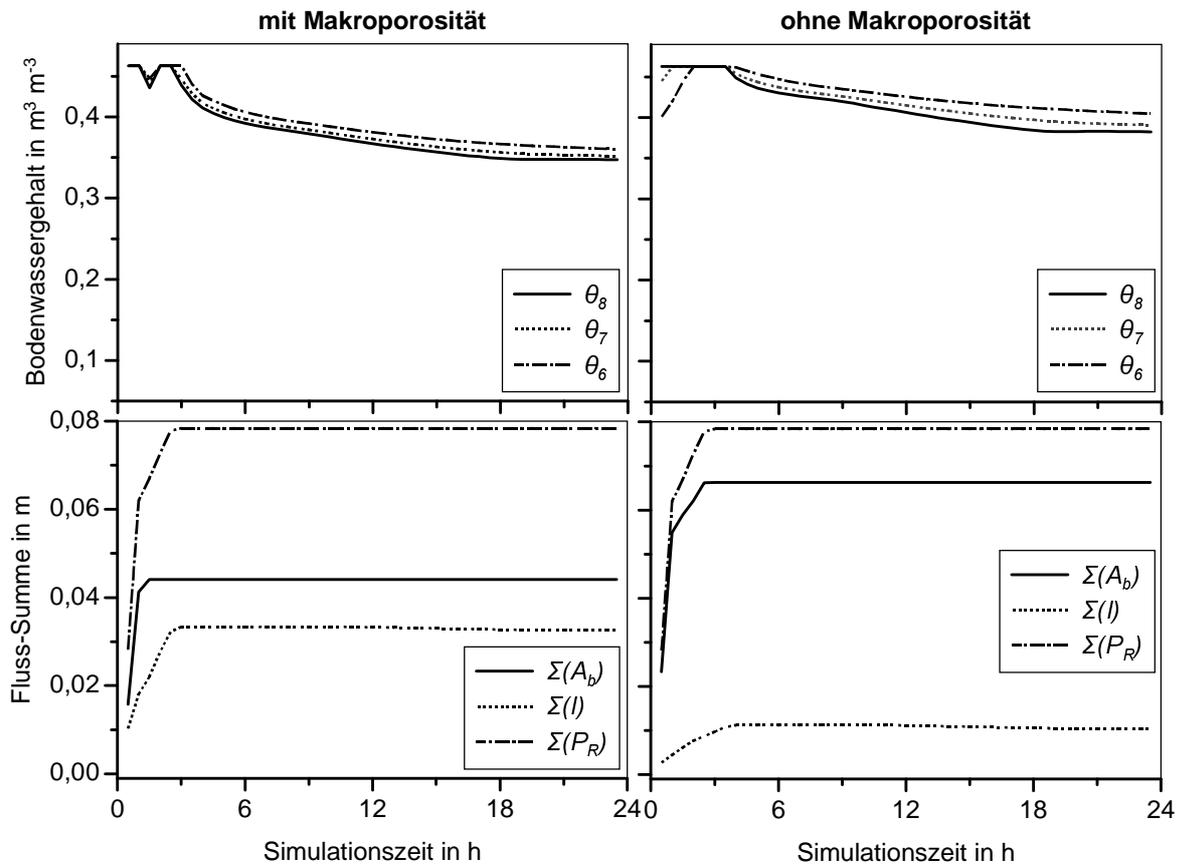
**Abbildung 4.28:** 24-stündige Simulation eines Niederschlagsereignisses mit ( $F_{K_s,\max} = 10$ , links) und ohne Makroporosität ( $F_{K_s,\max} = 1$ , rechts). Anfangswassergehalt:  $0,4 \text{ m}^3 \text{ m}^{-3}$ .
