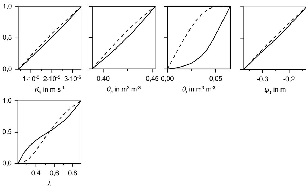
**Abbildung 4.16:** Kumulative Wahrscheinlichkeit des Eintretens der Ereignisse 'hohe Evapotranspiration' (gestrichelt) und 'niedrige Evapotranspiration' (durchgezogen) bei 5000 Simulationen mit einer Variation der Parameter über den jeweils in der Abszisse angegebenen Bereich. Karlsdorf, 25.07.1995.
