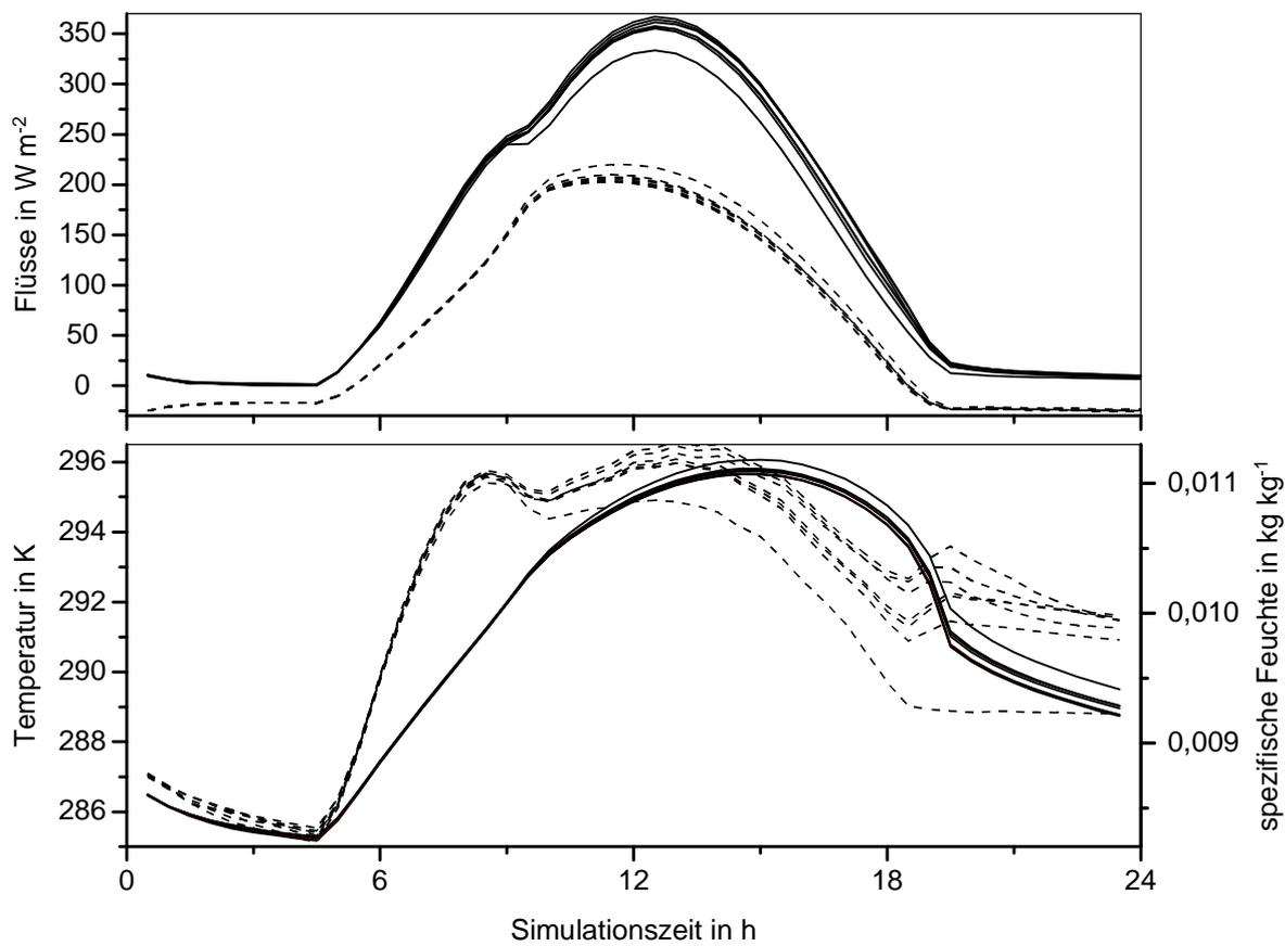
**Abbildung 4.31:** Evapotranspiration (oben, durchgezogen), fühlbarer Wärmestrom (oben, gestrichelt), Lufttemperatur in 2 m Höhe (unten, durchgezogen, linke Ordinate) und spezifische Feuchte in 2 m Höhe (unten, gestrichelt, rechte Ordinate) bei der Simulation mit sieben verschiedenen Parametrisierungen der bodenhydraulischen Funktionen. Bodenart: 'sandiger Lehm'.
