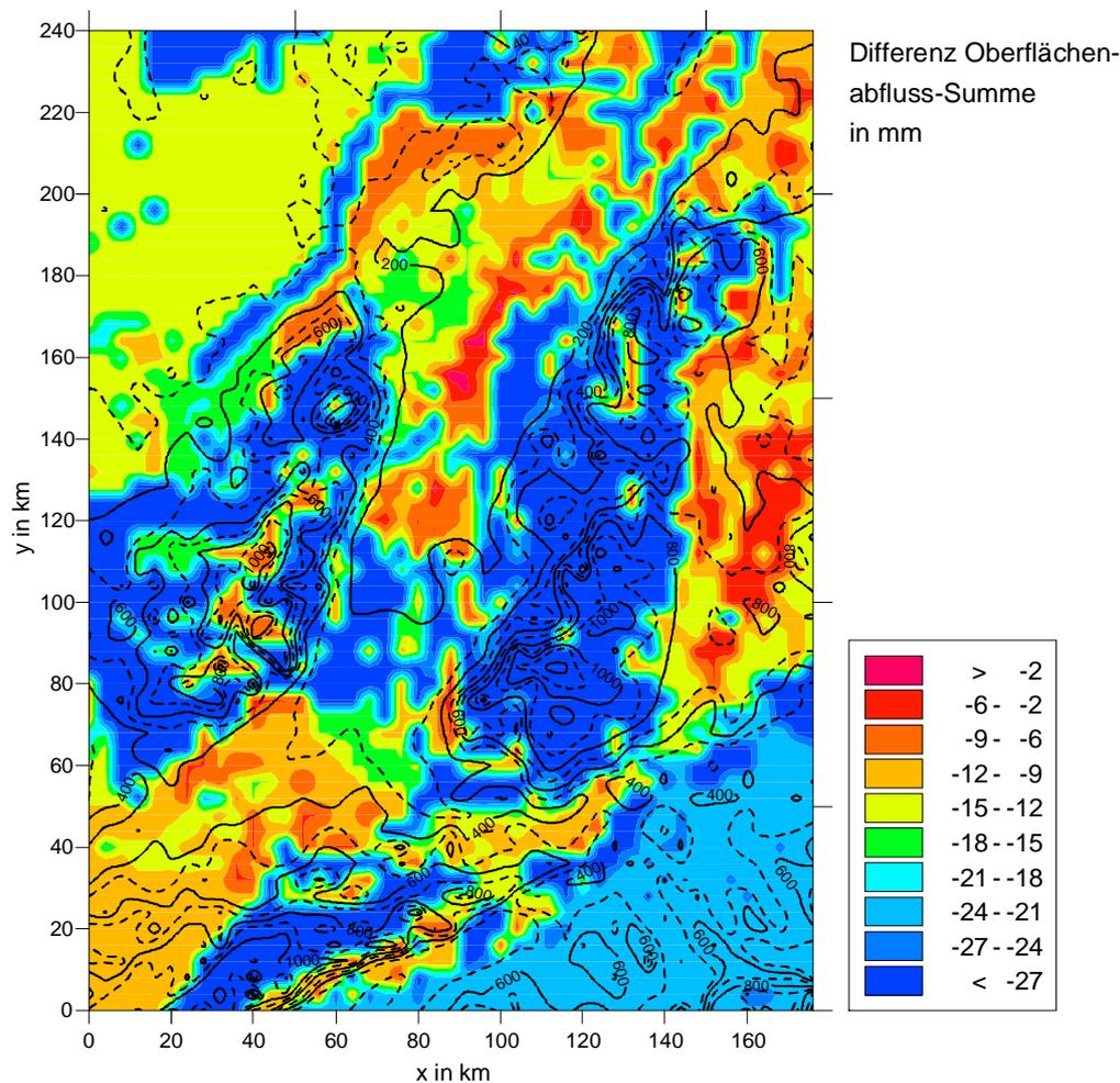
**Abbildung 4.54:** Differenz des aufsummierten Oberflächenabflusses der Simulation mit der C/CH- und der vG/RB-Parametrisierung.
