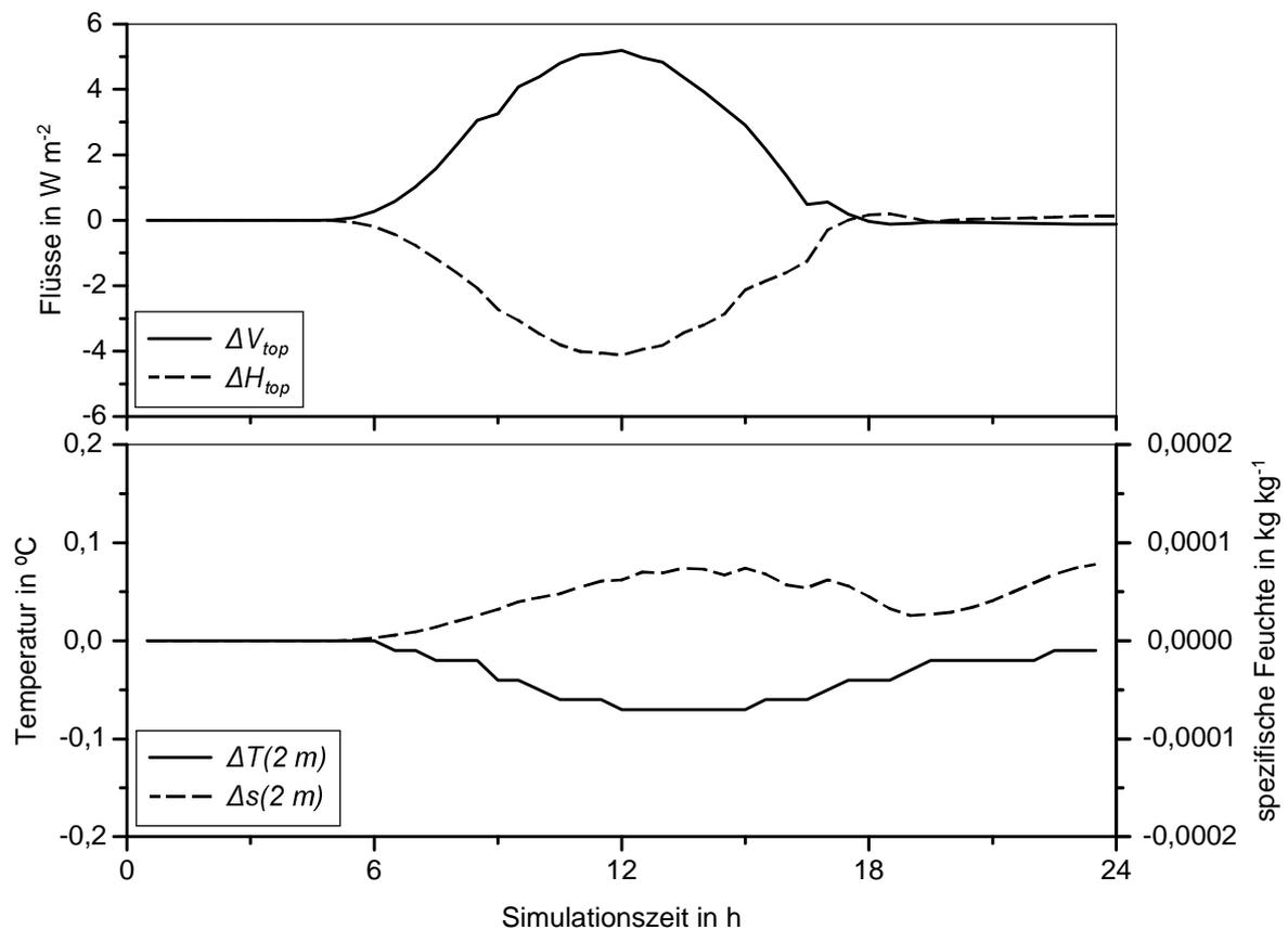
**Abbildung 4.25:** Differenz der Simulation mit einem Grundwasser-Flurabstand von 0,95 m und ohne Grundwasser. Bodenart: 'Sand', Vegetationsart: 'Laubwald'.
