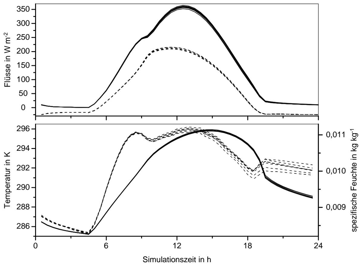
**Abbildung 4.30:** Evapotranspiration (oben, durchgezogen), fühlbarer Wärmestrom (oben, gestrichelt), Lufttemperatur in 2 m Höhe (unten, durchgezogen, linke Ordinate) und spezifische Feuchte in 2 m Höhe (unten, gestrichelt, rechte Ordinate) bei der Simulation mit sieben verschiedenen Parametrisierungen der bodenhydraulischen Funktionen. Bodenart: 'Lehm'.
