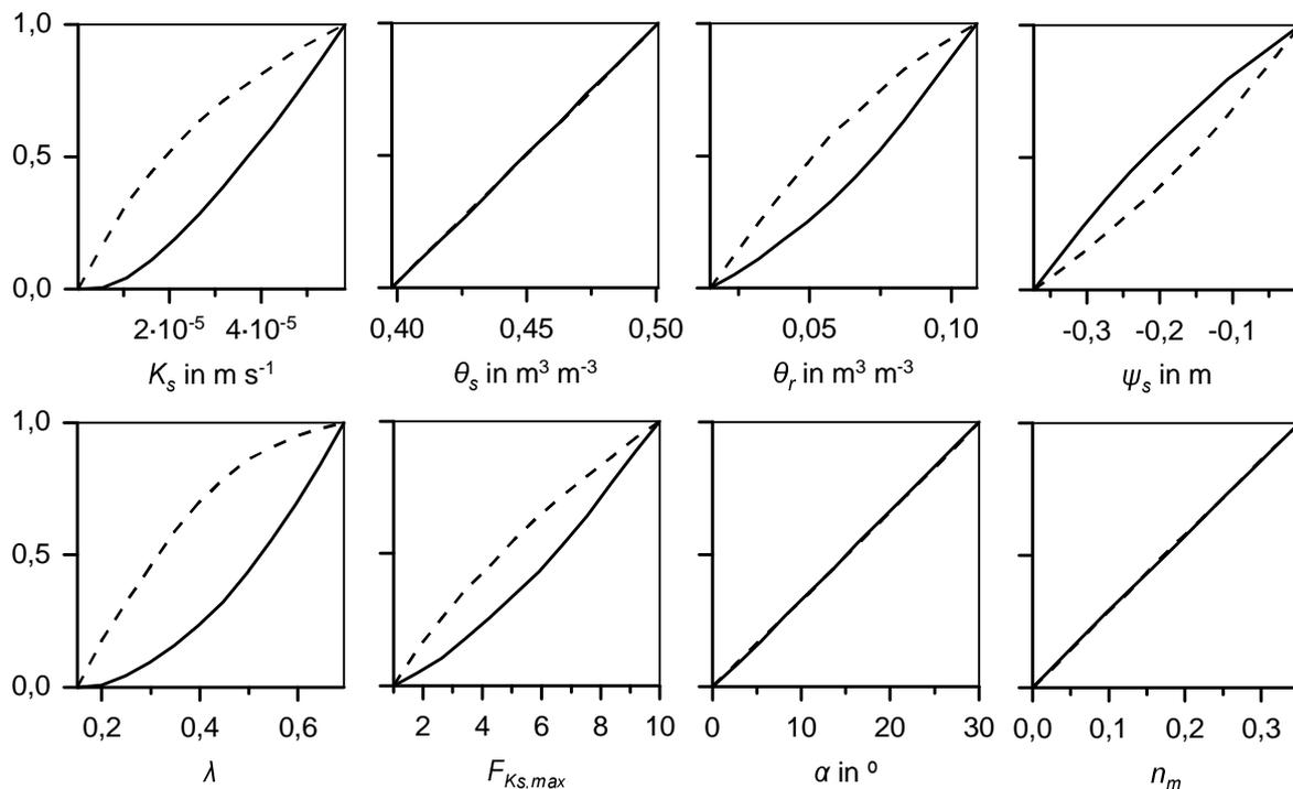
**Abbildung 4.19:** Kumulative Wahrscheinlichkeit des Eintretens der Ereignisse 'hohe Evapotranspiration' (gestrichelt) und 'niedrige Evapotranspiration' (durchgezogen) bei 8000 Simulationen mit einer Variation der Parameter über den jeweils in der Abszisse angegebenen Bereich. Karlsdorf, 17.05.1996 12.00 Uhr bis 18.05.1996 12.00 Uhr.
