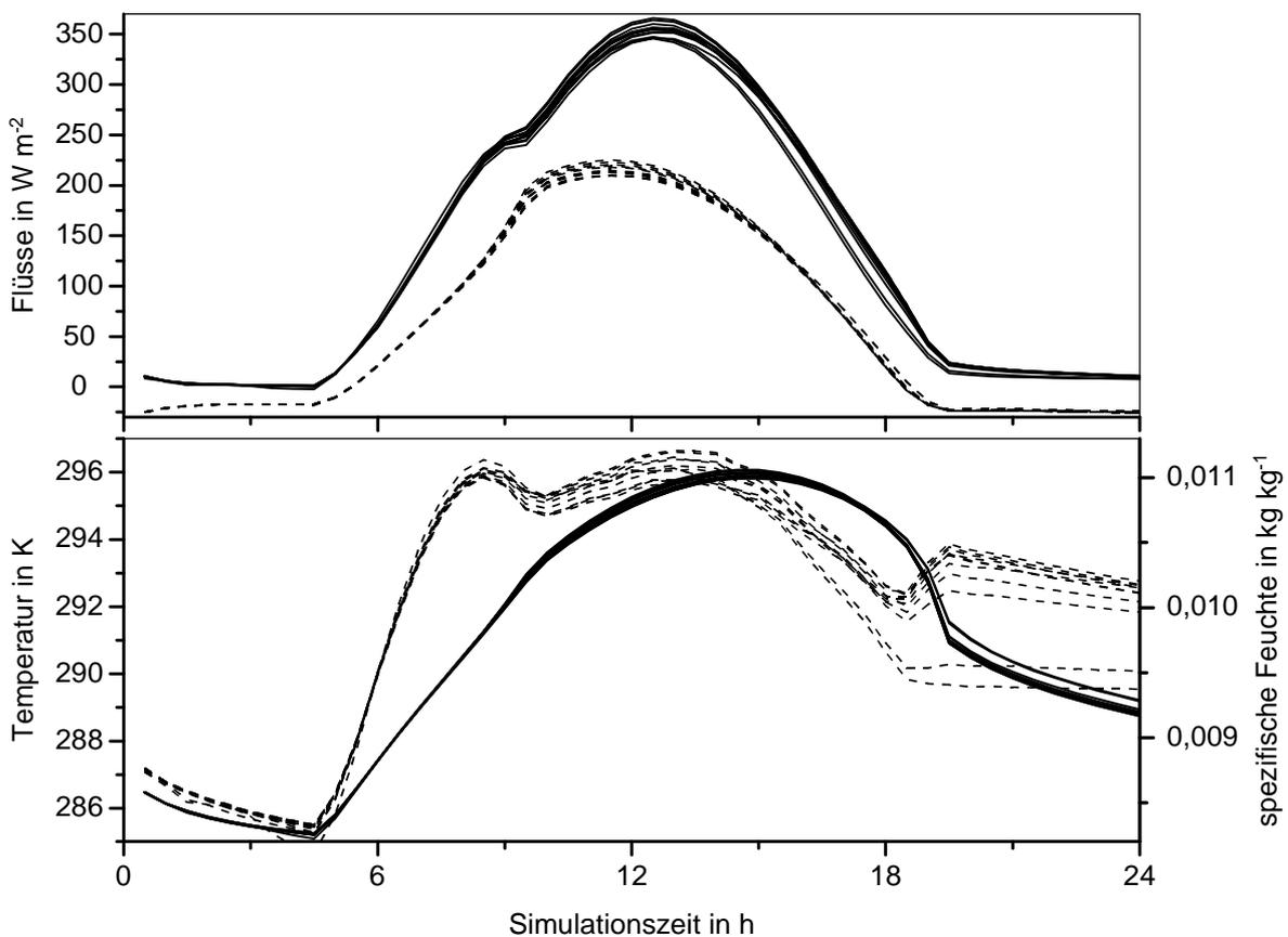
**Abbildung 4.32:** Evapotranspiration (oben, durchgezogen), fühlbarer Wärmestrom (oben, gestrichelt), Lufttemperatur in 2 m Höhe (unten, durchgezogen, linke Ordinate) und spezifische Feuchte in 2 m Höhe (unten, gestrichelt, rechte Ordinate) bei der Simulation mit zwölf verschiedenen Bodenarten der USDA-Klassifikation.
