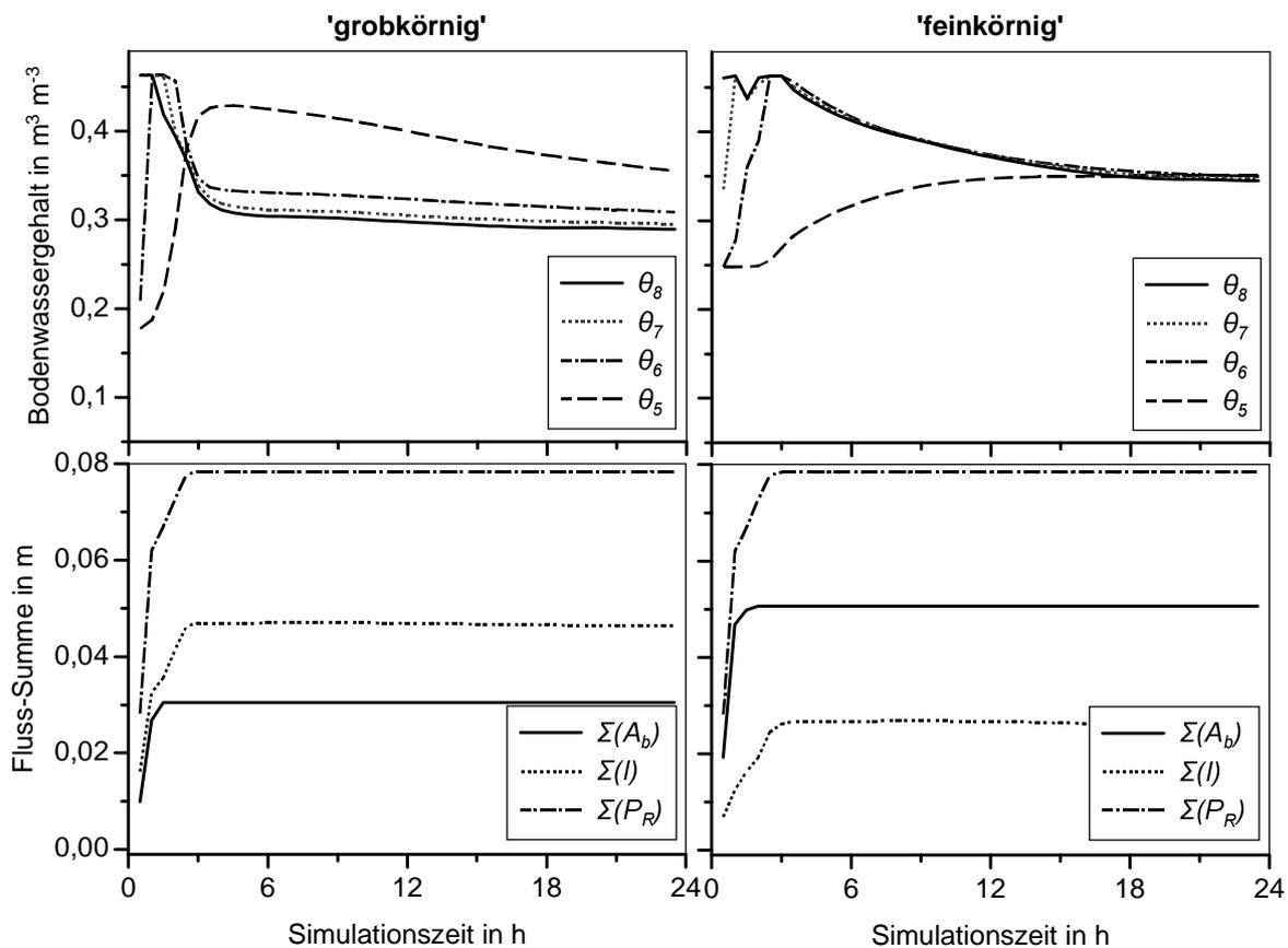
**Abbildung 4.34:** 24-stündige Simulation eines Niederschlagsereignisses. Bodenkennwerte entsprechend der Pedotransferfunktion nach RAWLS & BRAKENSIEK (1985) mit Volumenanteilen der Texturfractionen aus der Bodenart 'mittel' der 5-Klasseneinteilung (LENZ, 1996). Links 'grobkörnig', rechts 'feinkörnig'.
