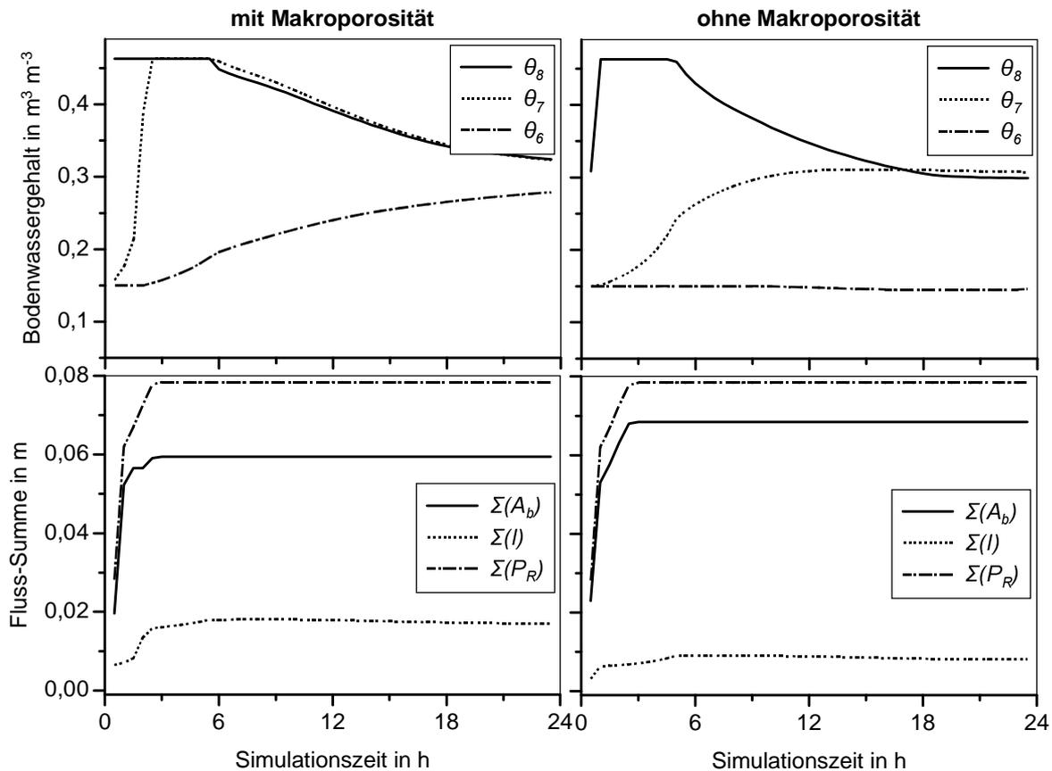
**Abbildung 4.26:** 24-stündige Simulation eines Niederschlagsereignisses mit ( $F_{K_s,\max} = 10$ , links) und ohne Makroporosität ( $F_{K_s,\max} = 1$ , rechts). Anfangswassergehalt:  $0,15 \text{ m}^3 \text{ m}^{-3}$ .
