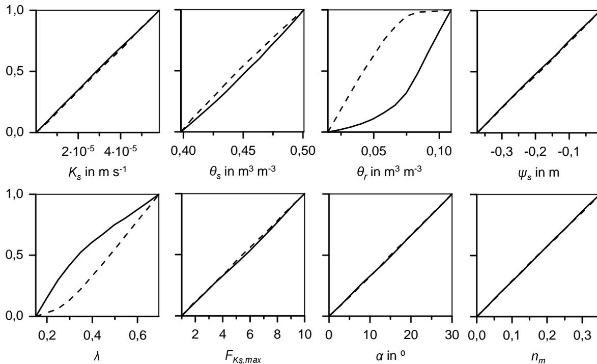
**Abbildung 4.13:** Kumulative Wahrscheinlichkeit des Eintretens der Ereignisse 'hohe Evapotranspiration' (gestrichelt) und 'niedrige Evapotranspiration' (durchgezogen) bei 8000 Simulationen mit einer Variation der Parameter über den jeweils in der Abszisse angegebenen Bereich. Karlsdorf, 25.07.1995.
