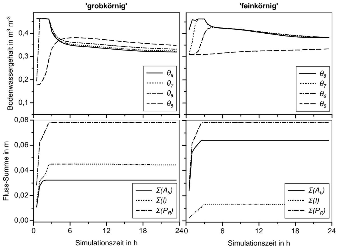
**Abbildung 4.36:** 24-stündige Simulation eines Niederschlagsereignisses. Bodenkennwerte entsprechend der Pedotransferfunktion nach RAWLS & BRAKENSIEK (1985) mit Volumenanteilen der Texturfractionen aus der Bodenart 'mittel' der USDA-Klasseneinteilung. Links 'grobkörnig', rechts 'feinkörnig'.
