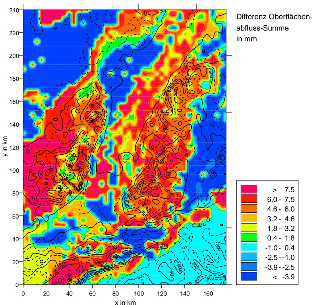
**Abbildung 4.57:** Differenz des aufsummierten Oberflächenabflusses der Simulation mit der Zuordnung von USDA-Bodenkennwerten und dem Referenzfall.
